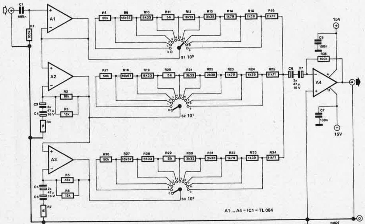
(avec R35); ils fonctionnent donc en atténuateurs. On obtient ainsi un amplificateur mélangeur dont le gain est variable.
