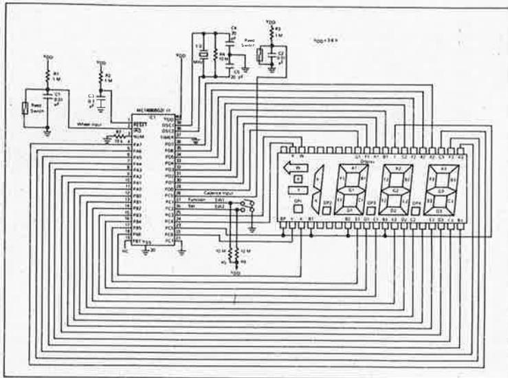
opérationnel. Les deux capteurs servent à fournir les interruptions et les impulsions nécessaires à certains compteurs. Les capteurs en question sont des relais reed (interrupteurs ILS) normalement ouverts activés par des aimant montés l'un sur la roue de la bicyclette et l'autre sur l'une des tiges reliant la pédale à l'axe du pédalier.
