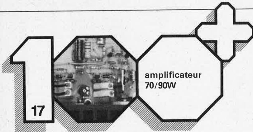
Bien que de conception relativement simple, l'amplificateur décrit ici peut fournir une puissance non négligeable et possède des caractéristiques très honnêtes. Pour pouvoir se passer de condensateur électrochimique en sortie, qui, à de telles puissances, prend rapidement un embonpoint gênant, nous avons opté pour une alimentation symétrique. Ceci explique la présence d'un amplificateur différentiel à
