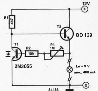
garantit une excellente photosensibilité. Notre photocommutateur est construit à l'aide de deux transistors, notre 2N3055 "trépané", (T1), et un transistor de commutation (T2). Ce dernier reçoit son courant de base par l'intermédiaire de R1, du moins tant que T1 est bloqué, ce qui est le cas tant qu'aucune lumière ne tombe sur T1. Dans ces conditions,
