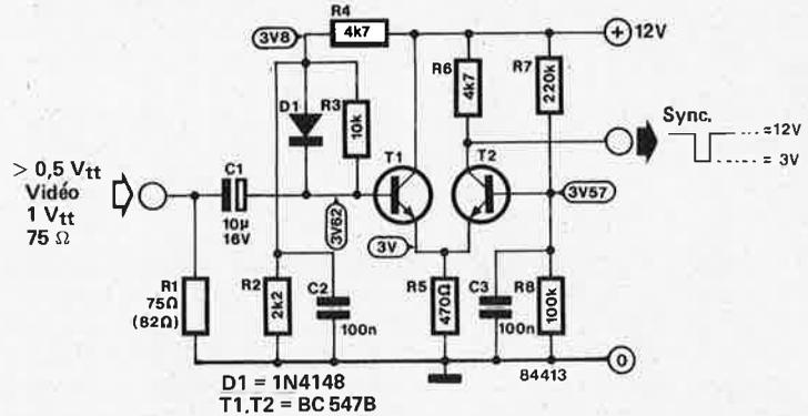
signal, T1 bloque, de sorte que les impulsions de synchronisation arrivent amplifiées à la sortie. Le circuit ne consomme pas plus de quelques mA.
