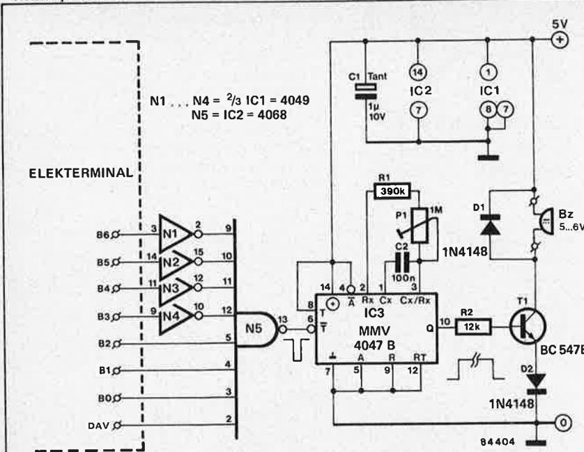
déterminée par les composants reliés aux broches 1, 2 et 3 et le potentiomètre P1. La sortie Q du 4047 passe au niveau logique haut, et y reste pendant un certain temps durant lequel retentira le signal émis par le ronfleur que commande T1. L'ensemble du circuit ne consomme guère que 11 mA.
