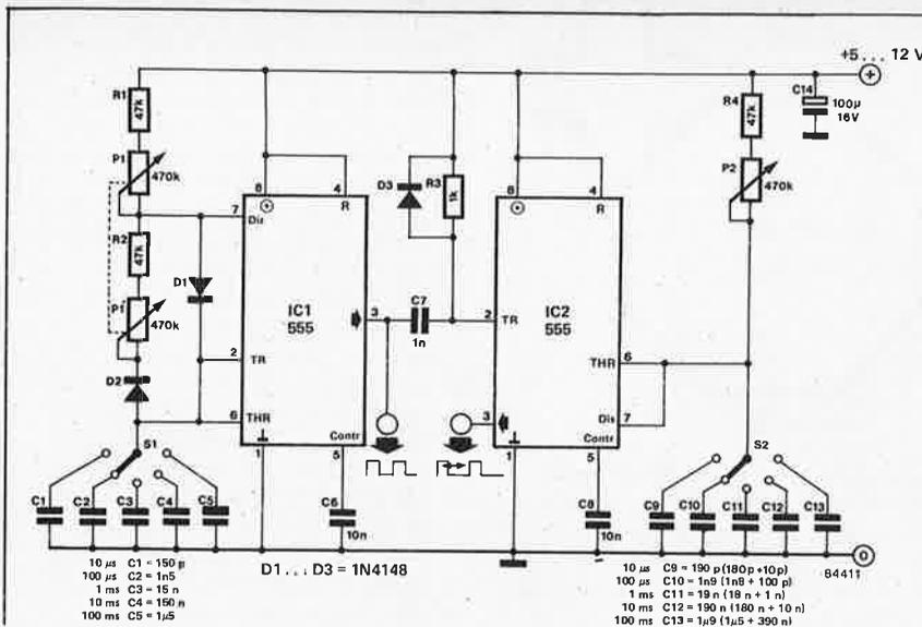
déclencher le second 555. Cet étage, qui est monté en monostable, est conçu pour fournir une largeur d'impulsion variable dont les valeurs vont de 10  $\mu s$  à 100 ms. Un réglage fin peut être effectué avec le potentiomètre. Le courant de sortie maximum de cet étage est également de 100 mA.
