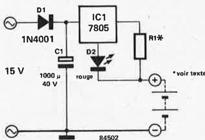
prise dans la ligne de masse du régulateur. Par cette connexion, circule un courant constant, (8 mA ±1 mA, qui est fonction du courant de sortie fixe), courant qu'il faut ajouter au courant de sortie. Lors du choix de la valeur de R1, il faut tenir compte de la chute de tension supplémentaire de 1,5 V due à la présence de la LED.
