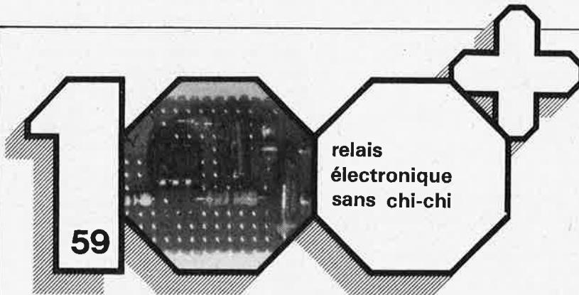
Le circuit intégré du type MOC 3040 ou 3041, permet de réaliser un relais électronique simplement et rapidement, relais qui, outre sa simplicité exemplaire, possède un certain nombre de caractéristiques particulièrement attrayantes. Le circuit contient un détecteur de passage par zéro, ce qui permet d'économiser un nombre de composants externes non négligeable. Le
