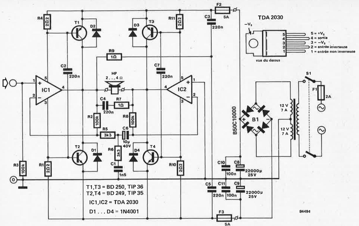
Le schéma de ce montage est un classique du genre et ne demande guère d'explications. Chaque moitié du pont est constituée par un TDA 2030 commandant deux transistors de puissance. Les diodes D1... D4 protègent les transistors contre les tensions inductives produites par la bobine du haut-parleur. Le gain de l'amplificateur en pont se calcule à l'aide de la formule suivante:
