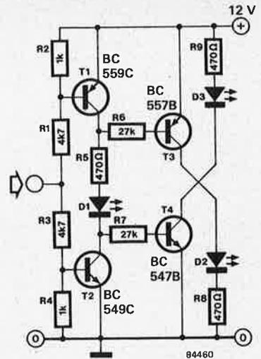
être dépassée lors des commutations. Si l'entrée (point nodal R2/R3) est déconnectée (mise en l'air), la tension d'entrée est égale à la moitié environ de la tension d'alimentation (6 V), et ainsi D1 s'allume. Le point nodal peut être aussi relié à la masse par une résistance de 5,6 kΩ, auquel cas ce sera D3 qui s'allumera.
