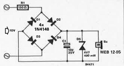
série qui empêchent cette tension de dépasser la tension maximale tolérée (5 V). Une résistance-série de 150 Ω (comme dans le schéma), convient à une tension d'entrée alternative de 10 V maximum environ. Si la tension en question dépasse cette valeur, il faut recalculer la valeur de cette tension en respectant la loi d'Ohm ( $U = R \cdot I$ ), sachant que le courant à travers le ronfleur ne doit pas dépasser 25 mA.
