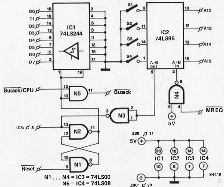
la masse sont pris directement sur le support à wrapper. Lorsque l'on a terminé la construction du montage, le connecteur de la platine vient prendre place dans le support du Z80, le support à wrapper recevant à son tour la CPU. Le nouveau signal BUSACK (broche 11 de IC4) est relié à la broche 26 du support d'origine de la CPU et la broche 3 de IC3 est reliée à la broche 8 du support de IC5 (qui a disparu!!) sur la carte Z80.
