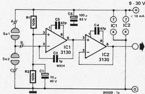
Et lorsqu'aucun doigt n'est posé ni sur Se1 ni sur Se2, la tension de sortie reste la même, car elle est "méorisée" si l'on peut dire, par C2. Comme on le sait, les trous de mémoire, ça existe aussi chez les condensateurs, sous forme de courants de fuite! En moyenne, la dérive de la tension mémorisée est
