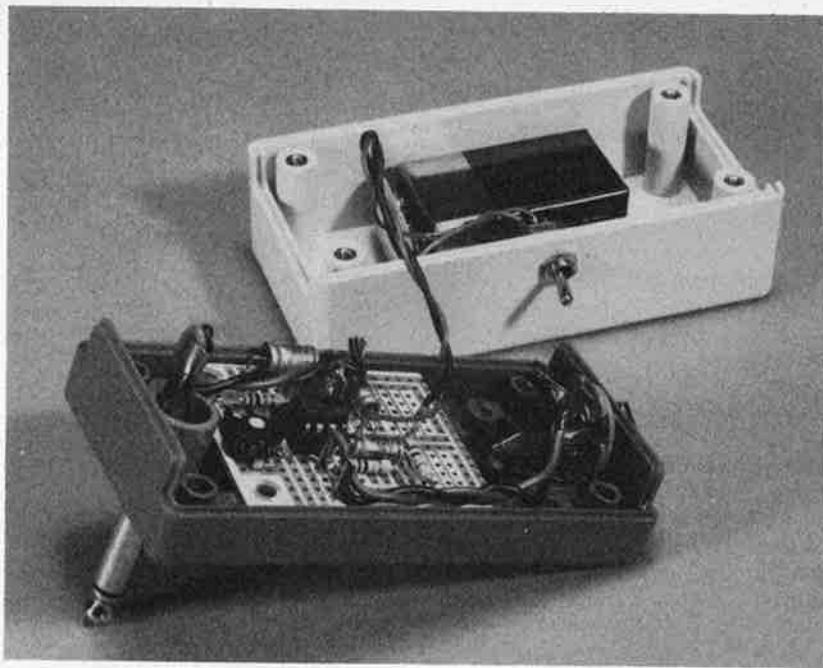
entrée à FET). Cette valeur convient à la majorité des capteurs électromagnétiques pour guitare. L'alimentation se fait à l'aide d'une pile compacte de 9 V. R4, R5, C3 et C4 transforment cette tension en une tension symétrique de + et -4,5 V nécessaire à l'alimentation de l'amplificateur opérationnel. La consommation de courant est faible, se situant aux environs de 5 mA.
