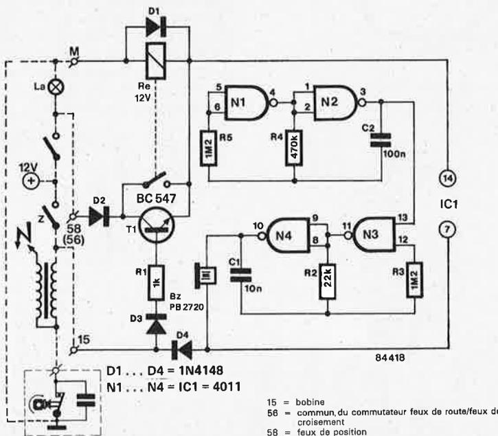
contact est coupé, il suffit de refermer l'interrupteur L, sans que pour autant on ait à supporter le signal d'alarme. Le circuit est remis en état
