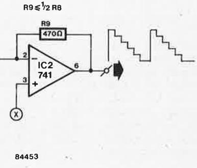
opérationnel sera réduite de moitié. La fréquence de ce signal est celle de la sortie de poids le plus fort d'IC1; la fréquence d'horloge appliquée à ce circuit intégré devra être 256 fois plus élevée que la fréquence de sortie souhaitée. Si l'on n'utilise pas une ou plusieurs des sorties de poids fort, le rapport entre la fréquence d'horloge et la fréquence de
