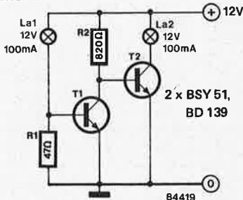
Son principe est simple. Tant que La1 est allumée, (pour simplifier la compréhension du fonctionnement, nous avons supposé que l'ampoule d'origine La1 signalait une panne), une partie du courant qui traverse l'ampoule arrive à la base de T1, de sorte que ce transistor est conducteur. De ce fait, la base de T2 est à un potentiel proche de la masse: ce transistor est bloqué; dans ces conditions, il ne circule pas de courant à travers l'ampoule (La2) prise dans la ligne de collecteur de T2.
