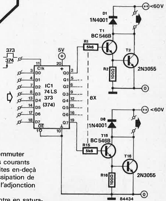
de sortie existants: les huit lignes de l'un (port B par exemple) tiendront lieu de bus de données commun à toutes les bascules, et les huit lignes de l'autre (port A) délivreront le signal d'horloge de chacun des circuits à bascules mis en oeuvre. On peut ainsi commander jusqu'à 64 darlington à l'aide de deux ports de sortie programmables.
