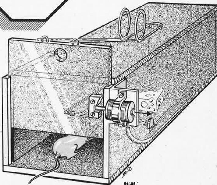
commande à son tour un électro-aimant ou un solénoïde disposés de telle façon que lorsqu'ils sont activés la porte se ferme. L'impulsion de commande dure environ une seconde, ce qui suffit largement, quel que soit le système adopté. La présence de la bascule N1/N2 assure au montage une immunité totale aux redéclenchements intempestifs que ne manquera pas de provoquer la souris en faisant les cent
