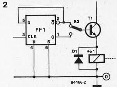
niveau logique haut lorsque son entrée reçoit un flanc d'impulsion ascendant, c'est-à-dire lorsque l'on ouvre la porte de la lieu. Aussitôt T1 devient passant, le relais colle et la lumière s'allume. La sortie de la bascule FF1 ne repassera au niveau logique bas que lorsque l'on rouvrira la porte, c'est-à-dire lorsqu'apparaîtra un nouveau flanc ascendant. Aussitôt la lumière s'éteindra. La tension de service du relais devra être comprise entre 5 et 15 V (tension d'alimentation).
