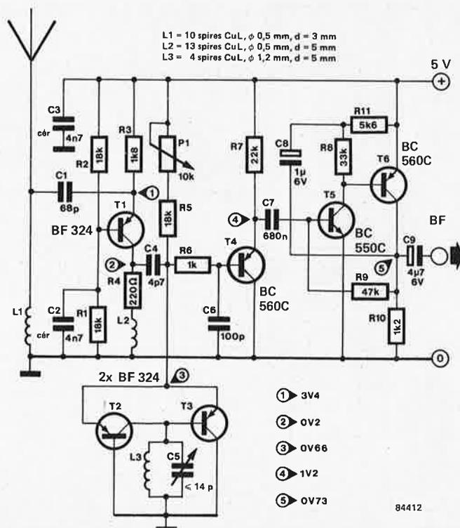
émetteur, il suffirait d'une faible variation de la tension présente aux bornes de la paire P1/R5 pour le moduler en fréquence. Inversement, (d'où l'expression d'émetteur à l'envers), si le signal est, pour une raison ou une autre, modulé, (la modulation du signal de l'émetteur dans ce cas-ci), il en résulte des variations de la tension aux bornes de P1/R5. Ces variations de tension
