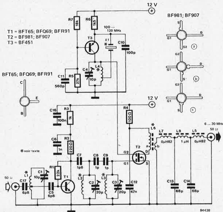
que), doit être égale à la différence entre la fréquence de réception et celle de sortie, ( $f_{\text{ent}} - f_{\text{Xs}} = f_{\text{sor}}$ ), sachant qu'il faut choisir la fréquence de sortie la plus élevée possible. Pour la bande des 2 mètres, la valeur idéale de la fréquence du quartz est de 116 MHz ( $144...146 - 116 = 28...30$  MHz).
