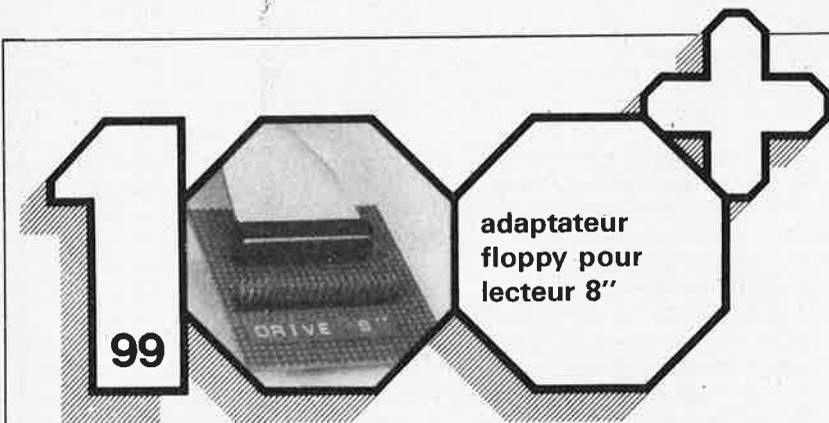
Le terme de "circuit" ne convient pas tout à fait à ce "montage". Deux connecteurs (l'un à 50 broches, l'autre à 34) et un morceau de câble en nappe multibrins (à 50 brins), il ne faut rien de plus pour connecter un lecteur de disquettes 8" à une interface prévue pour un lecteur 5" (appellation commune du lecteur 5" 1/4). La technologie évoluant à pas
