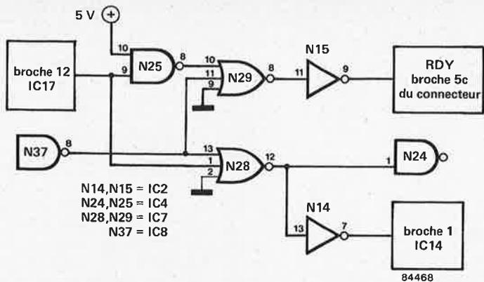
puisque'elle se trouve déjà à la masse. N'oubliez pas de relier les broches 1 de IC14 et 12 de IC17 à l'aide d'une petite liaison, ces deux broches devant se retrouver dans leurs supports. A noter au passage qu'il est possible d'autre part de faire en sorte que la fenêtre dans laquelle apparaissent les caractères sur l'écran ressorte nettement. Il suffit pour cela d'ajouter une résistance de 1 k sur la carte VDU, résistance reliant la broche 5 de IC17 au collecteur de T1.
