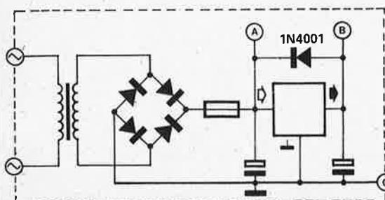
Si l'alimentation protégée est déjà pourvue d'un fusible, on devra souder un strap sur le circuit imprimé en lieu et place du fusible F1. De plus, Z est dans ce cas relié à Y. Si toutefois, on utilisait le fusible F1, on reliera Z à X. Finalement, on notera que IC1 doit être alimenté en amont de l'alimentation protégée.
