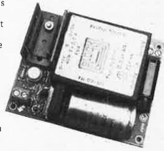
Ce kit est une alimentation entièrement protégée dont la tension de sortie peut être réglée très précisément à l'aide d'un ajustable multi-tours.
