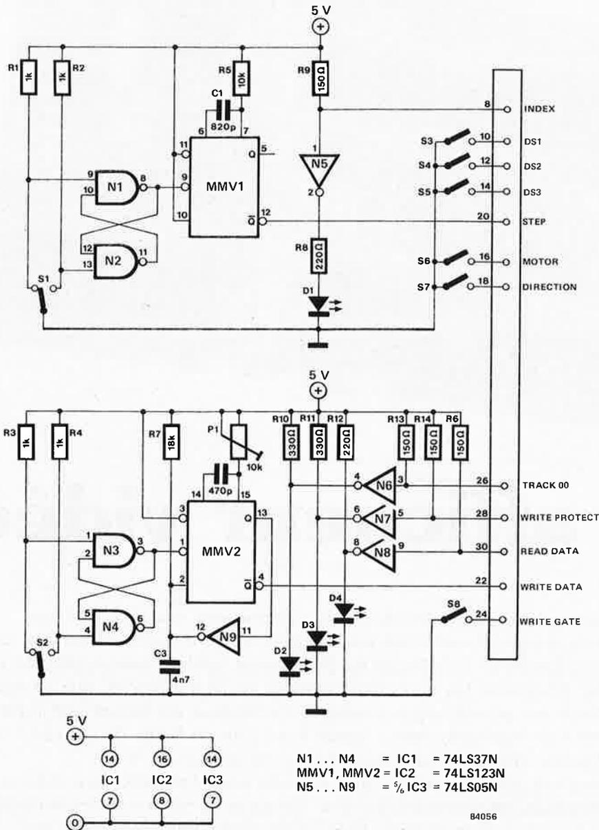
Figure 1. Bien que simple, ce circuit est capable de fournir à un lecteur de disquettes les impulsions de commande pour le déplacement de la tête et un train d'impulsions calibrées en guise de données à écrire sur une piste. La visualisation de la lecture de données est obtenue le clignotement de la LED D4.
