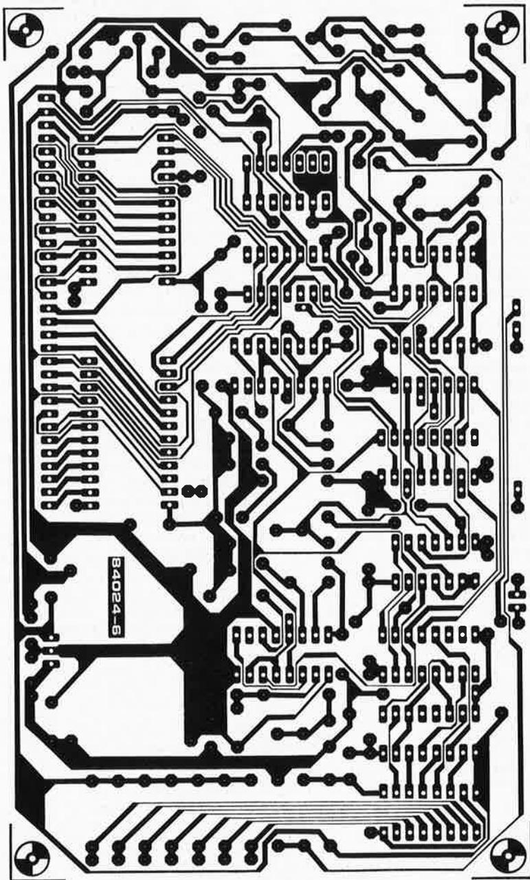
Figure 6. Pour faciliter le câblage de l'afficheur (câble en nappe), les points de connexion ont été rassemblés de part et d'autre du circuit imprimé conçu pour le schéma de la figure 2. La réalisation des circuits de la figure 4 et de la figure 5 est laissée à l'initiative de chacun.
