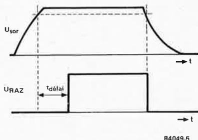
Figure 5. La mise en fonction du circuit de temporisation permet d'envoyer un signal de RAZ-système à un système à  $\mu P$ . L'entrée de RAZ est libérée dès que la tension de sortie est présente pendant une certaine durée.
