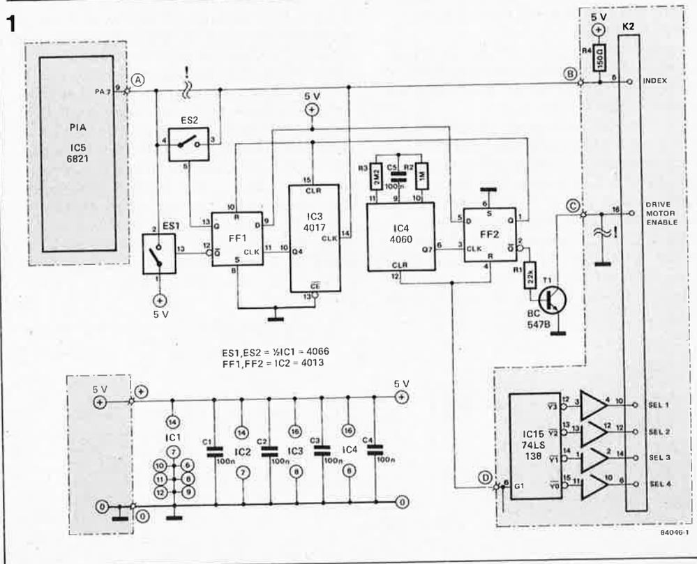
n'est permis d'utiliser directement le signal d'adressage d'un lecteur (SEL) comme signal DRIVE MOTOR ENABLE que si l'on procède à une élimination des premières impulsions d'index encore inutilisables. D'autre part, cette façon de faire provoque l'arrêt du moteur d'entraînement aussitôt que l'unité est désactivée: ceci n'est pas très opportun lors d'accès successifs à cadence rapide sur une disquette. Il est préférable que le moteur continue de tourner encore pendant quelques instants.
