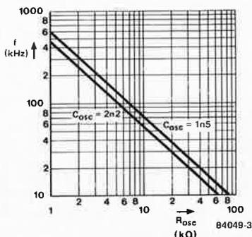
Figure 3. La résistance  $R_{osc}$  et le condensateur  $C_{osc}$  donnent le choix de la fréquence d'oscillation.
