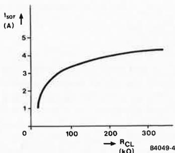
Figure 4.  $R_{CL}$ , prise entre la broche 4 et la masse, définit la limitation en courant. Si cette broche se trouve en l'air, la sortie de courant peut atteindre 5 A au maximum. Si on choisit une limitation en courant réglable, on utilisera un potentiomètre logarithmique de 500 kΩ.
