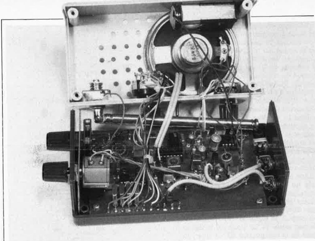
bâtonnet de ferrite de l'antenne et la pile. Les photos d'illustration montrent la solution que nous avons adoptée; il faut cependant veiller à raccourcir les liaisons autant que possible.
