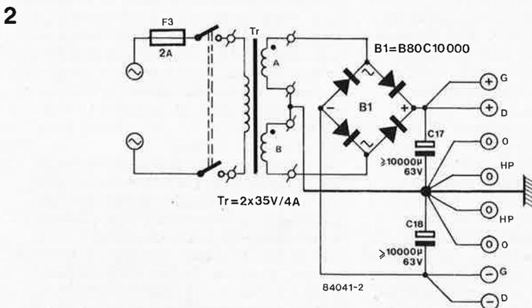
Figure 2. Une alimentation peu sophistiquée convient parfaitement dans le cas d'un amplificateur. Il est préférable de ne pas lésiner sur la taille du transformateur et des condensateurs électrochimiques. L'alimentation décrite ici est celle convenant à la version stéréo du mini-crescendo. Si vous construisez la version mono, un transformateur de 2A un fusible de 1A, et des condensateurs de 5 000μF sont suffisants.
