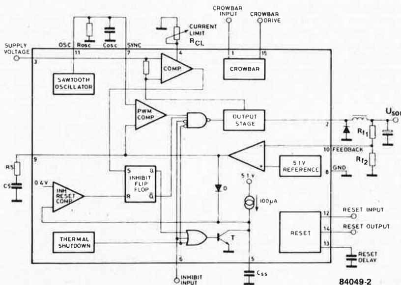
Figure 2. Synoptique simplifié d'un circuit intégré conçu spécialement pour les alimentations à découpage.
