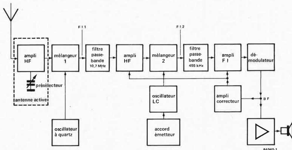
Figure 1. Le récepteur O.C. utilise le principe du super double: 1ère FI -> 10,7 MHz, 2ème FI -> 455 kHz.
