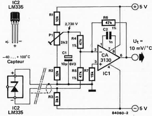
Figure 2. Le capteur de température. Par action sur P1, on fait en sorte que la tension de sortie (broche 6) du CA3130 soit nulle à 0°C. La broche *ajust* du LM335 reste en l'air.
