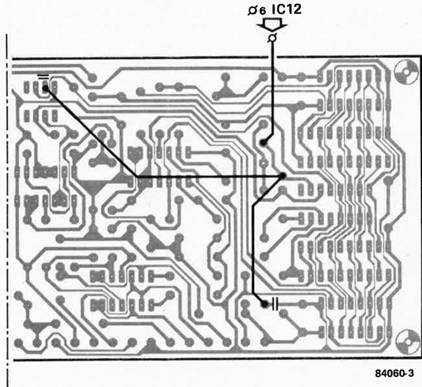
Figure 3. Deux interruptions de piste sont à effectuer sur le dessin du circuit imprimé. Il faut ensuite ajouter deux liaisons et supprimer le pont courant le long de C9 et de R16.
