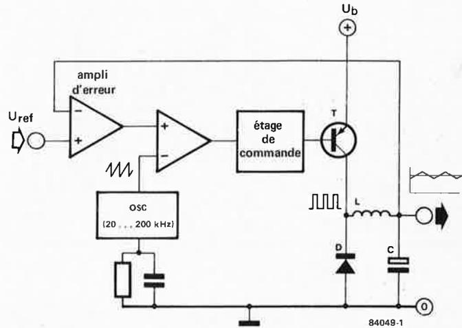
Figure 1. Schéma synoptique d'une alimentation à découpage.
