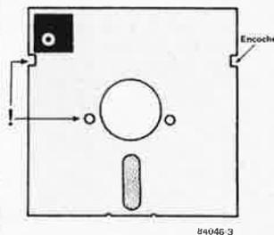
Figure 3. L'envers d'une disquette en vaut bien l'endroit. Pour utiliser le verso d'une disquette simple face, il suffit d'y percer (avec le plus grand soin) un trou d'index (recto-verso) et une encoche symétriques par rapport aux orifices originaux.
