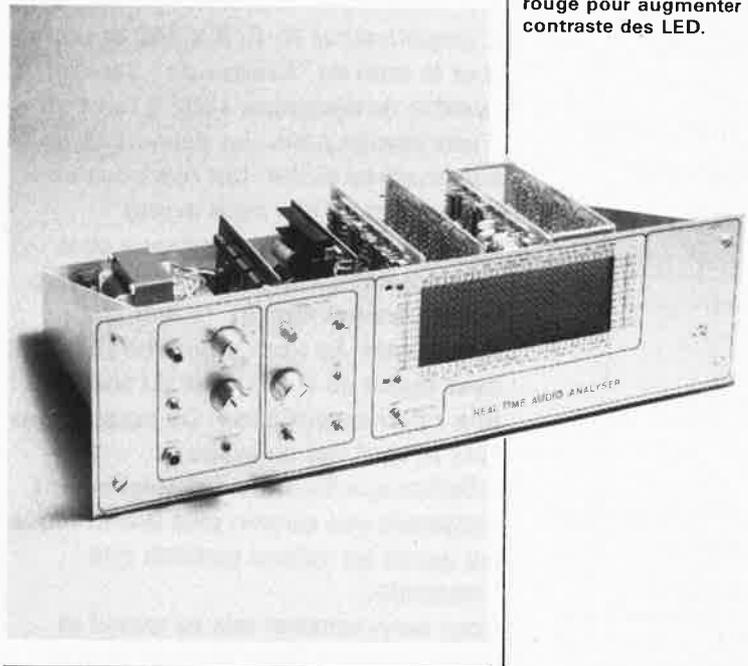
Figure 3. Sa taille imposante nous interdit de publier la face avant à l'échelle 1:1. Lors de la mise en oeuvre de l'affichage, n'oubliez pas de prévoir une plaque en verre acryl ou un film rouge pour augmenter le contraste des LED.
