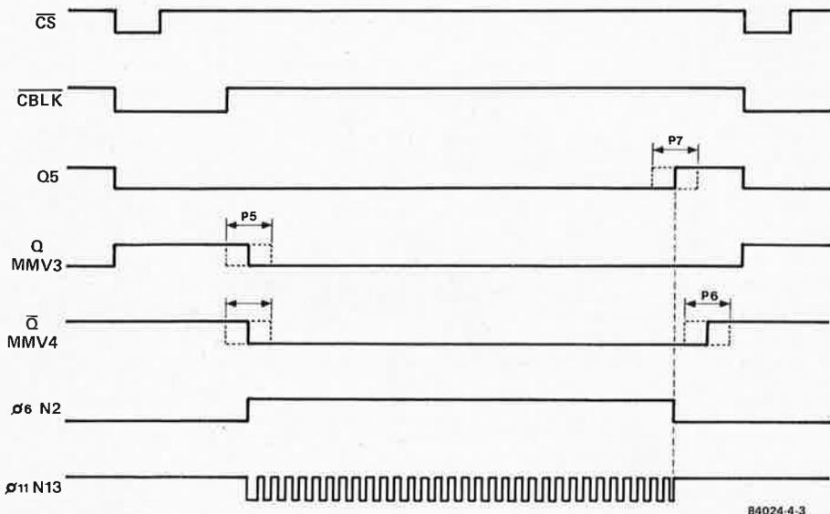
Figure 3. Avec ce chronogramme des signaux responsables de l'organisation horizontale de l'image, on saisira mieux le fonctionnement de la logique de commande autour de N13 (MMV3 et 4, N1, N2, N5 et N6).
