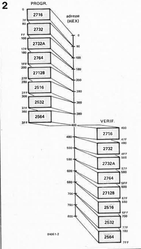
Figure 2. Topographie de la mémoire. Elle contient les sous-programmes permettant la programmation et la vérification de 8 types d'EPROM différents.
