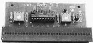
Ce kit est un voltmètre analogique composé de 30 Leds. En fonction de la tension d'entrée, une des 30 Leds s'allumera. L'échelle des 30 Leds peut être montée à l'équerre sur le circuit imprimé afin de limiter l'encombrement de la face avant (15 x 76 mm).
