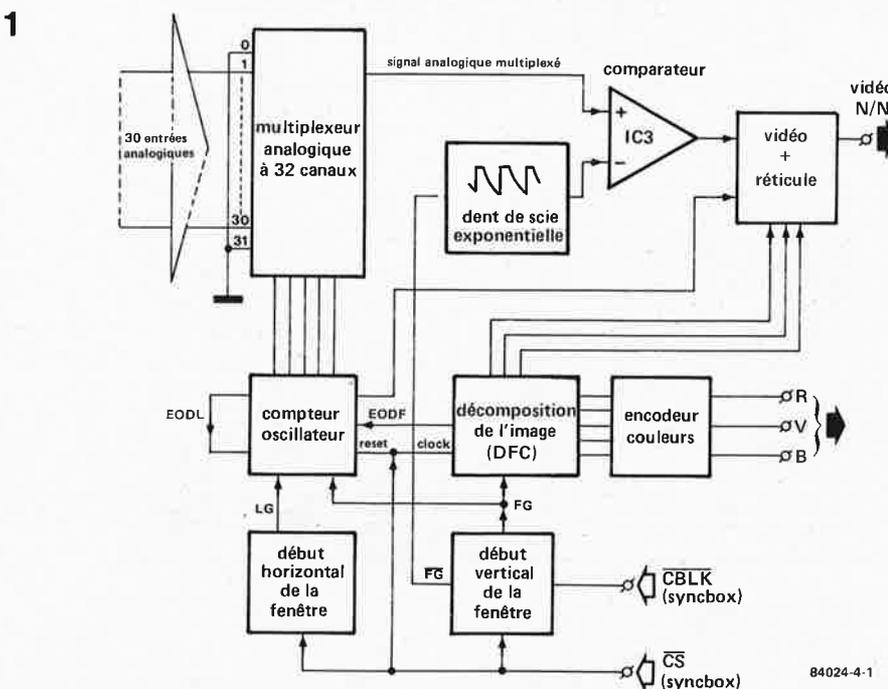
Figure 1. L'afficheur vidéo est une interface entre des modules analogiques (jusqu'à 30) et un écran (moniteur vidéo). Il génère un signal vidéo à partir des signaux de synchronisation fournis par le générateur de signaux vidéo de test publié ailleurs dans ce numéro.
