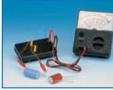
Le contrôleur que nous vous présentons NE mesure PAS la capacité en  $\mu\text{F}$  d'un condensateur électrolytique, mais il contrôle seulement sa RES (en anglais ERS: "Equivalent Serie Resistance"). Grâce à cette mesure, on peut établir l'efficacité restante d'un condensateur électrolytique ou savoir s'il est à ce point vétuste qu'il vaut mieux le jeter.
