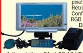
Résolution: 333 960 pixels. Standard: PAL. Rétroéclairage: CCFT. Configuration pixels: RGB Delta. Effet miroir. Dimensions: 200x125x40 mm. Niveau du signal vidéo: 1 Vpp / 75  $\Omega$ . Tension d'alimentation: CA et CC 12 VDC. Livré avec pied, câbles de raccordement, télécommande, alimentation voiture et secteur.
