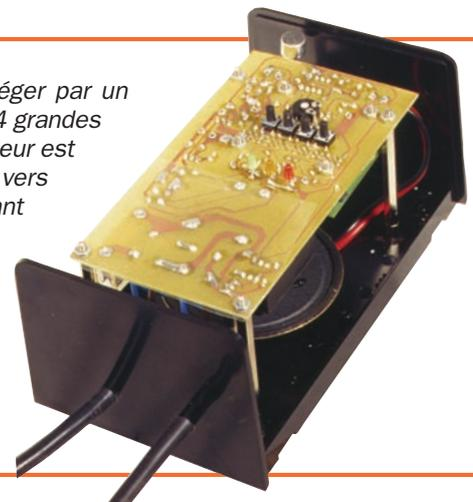
Figure 3 : L'installation dans le boîtier plastique.
