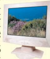
Moniteur de dimensions compact au design moderne. Utilisation possible comme moniteur pour ordinateur de vidéosurveillance. Résolution: XGA 1024x768. Angle visuel: 60° droite/gauche 45° haut/bas. Niveau du signal vidéo: 1 Vpp / 75  $\Omega$ . Standard: PAL/NTSC. Tension d'alimentation: 12 VDC  $\pm$  10 %. Dimensions: 392x327x53 mm. Poids: 5 200 g. Accessoires: pied, câbles de raccordement, télécommande et alimentation voiture.
