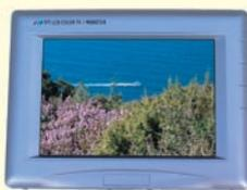
Moniteur basse résolution de 5,6". Standard: PAL. Affichage: matrice active. Nombre de pixels: 224 640. Niveau du signal vidéo: 1 Vpp / 75  $\Omega$ . Tension d'alimentation: DC 11 à 13 VDC. Consommation: 8 W. Dimensions: 165x135x40 mm.
