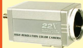
Télécaméra couleurs compacte à haute résolution avec zoom optique 22x et zoom numérique 10x, pour une utilisation professionnelle. Elle offre la possibilité de programmer toutes les fonctions principales : OSD, autofocus, contrôle par clavier situé à l'arrière du boîtier, télécommande ou ligne de communication série TTL/RS485.
