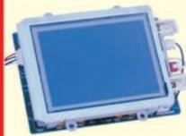
Standard: PAL. Affichage: matrice active. Ecran: 10 cm. Nombre de pixels: 89622. Dimension du point 0,259 x 0,210. Résolution: 383 x 234. Configuration pixels RGB Delta. Rétro éclairage: CCFT. Niveau du signal vidéo: 1 Vpp / 75  $\Omega$ . Alimentation: 12 Vcc. Conso.: 7 W. Dimensions: 122x84x36 mm. T° de fonctionnement: -5 °C à +40 °C. Durée minimum de vie: 4 000 h.
