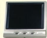
Moniteur haute résolution 5,6". Standard: PAL. Affichage: TFT matrice active 5,6". Nombre de pixels: 224 640. Résolution: 960x234. Dimension surface active: 115x85 mm. Niveau du signal vidéo: 1 Vpp / 75  $\Omega$ . Tension d'alimentation: 12 à 13VDC. Dimensions (5,6"): 163x145x30 mm. Dimensions (6,4"): 170x150x35 mm. Température de fonctionnement: -5 °C à +40 °C. Livré avec pied. Poids: 700g.
