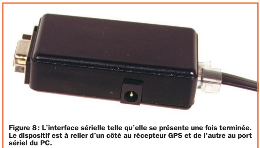
**Figure 8: L'interface sérielle telle qu'elle se présente une fois terminée. Le dispositif est à relier d'un côté au récepteur GPS et de l'autre au port sériel du PC.**
