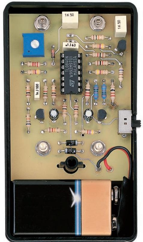
Figure 6 : Installation dans le boîtier plastique du contrôleur de RES pour électrolytique. Dans la partie inférieure, on voit la pile 6F22 dans son logement.
