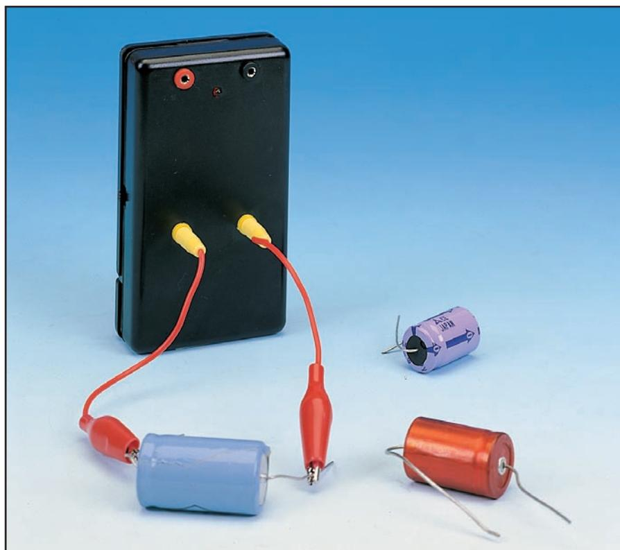
Figure 9 : Plus les condensateurs électrolytiques sont vétustes (périmés), plus faible est la valeur en  $\mu\text{A}$  lue sur le multimètre (figure 11). Si un électrolytique est en court-circuit, vous verrez tout de suite s'allumer DL1.
