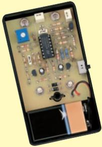
Le contrôleur que nous vous présentons NE mesure PAS la capacité en  $\mu\text{F}$  d'un condensateur électrolytique, mais il contrôle seulement sa RES (en anglais ERS: "Equivalent Serie Resistance"). Grâce à cette mesure, on peut établir l'efficacité restante d'un condensateur électrolytique ou savoir s'il est à ce point vétuste qu'il vaut mieux le jeter plutôt que de le monter!
