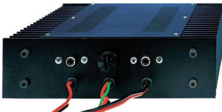
**Figure 15 :** Comme le montre la photo, sur les deux radiateurs sont fixés, par boulons, le panneau arrière et la face avant, puis, par vis, les couvercles supérieur et inférieur.
