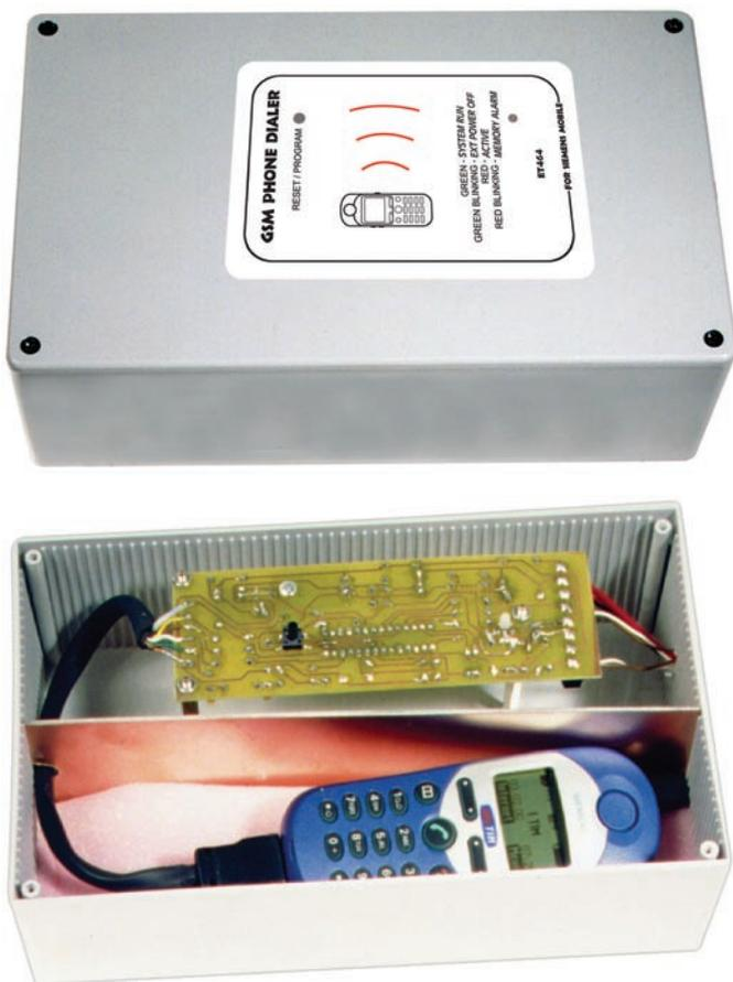
Tout le système peut être logé dans un boîtier plastique: la platine du transmetteur téléphonique mais aussi le téléphone portable Siemens 35 et son câble avec connecteur spécial (on peut choisir le téléphone portable Siemens S35, C35 ou M35 mais pas le A35 car il n'a pas de modem interne). N'oubliez pas les blindages (voir texte de l'article).
