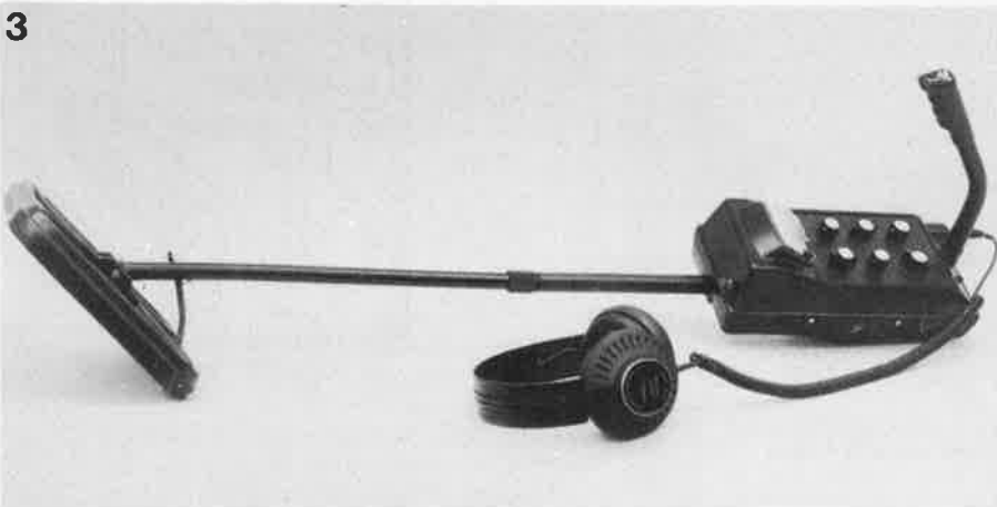
Photo 3. Il est possible d'ajuster à "sa main", la distance entre la bobine et le manche.
