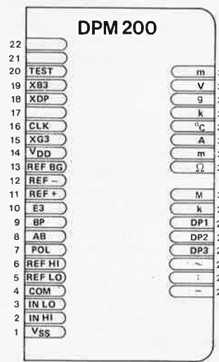
Figure 2. Voici les diverses connexions disponibles sur le module, ainsi que leur signification.
