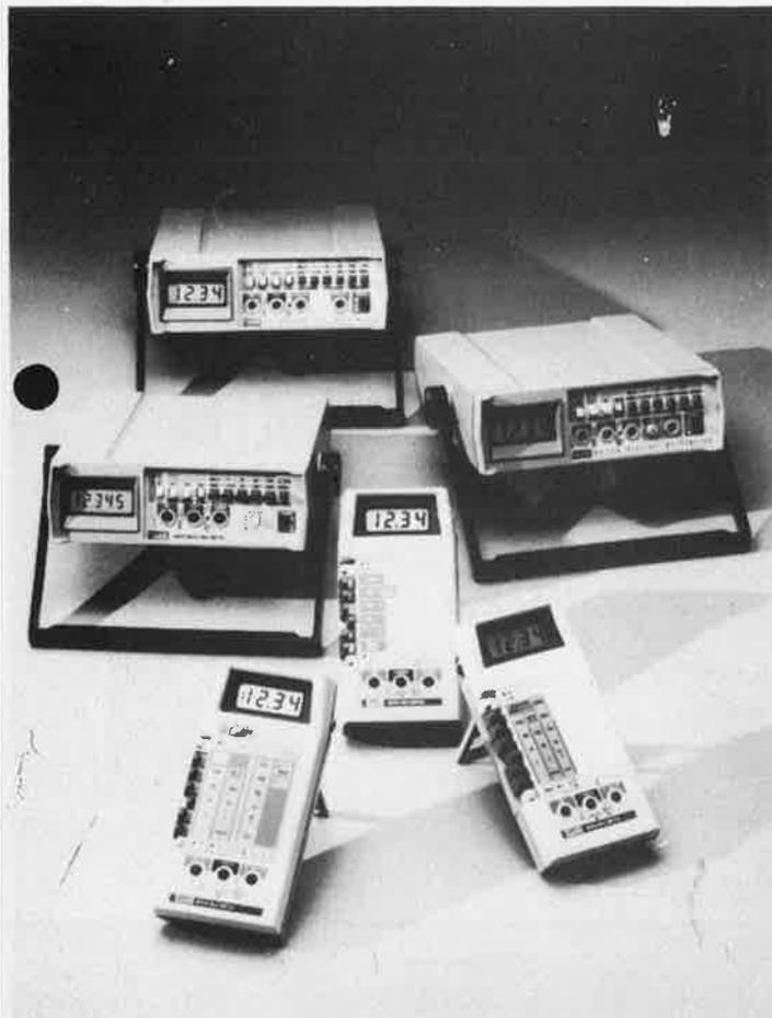
**MODELE 8010A:** modèle de table avec une qualité exceptionnelle de mesure effective jusqu'à 50 kHz
