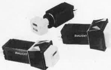
Ces boutons poussoirs complètent la gamme de la série 554 à contact mécanique et sont compatibles mécaniquement avec ceux-ci pour un montage par l'avant ou par l'arrière du panneau (épaisseur du panneau de 1,57 mm à 4,76 mm).
