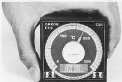
Le E5A est équipé de LED rouges et vertes permettant le contrôle de l'état de sortie du relais. Le réglage de l'hystérésis dans la version "tout ou rien" est ajustable entre 0,5 et 3% de l'échelle totale. Bien sûr, la compensation de soudure froide et la protection de rupture de couple sont fournies en modèles standards.
