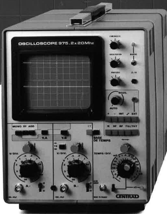
Le 975 de CENTRAD est un oscilloscope 100 % français. Conçu à partir des techniques nouvelles. Il est équipé entièrement de circuits intégrés et de semi-conducteurs.
