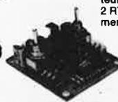
Boîtier émetteur avec pile : 92x57x22 mm. Récepteur avec 4 relais 1RT contact 2A : 72x50x24 mm.
