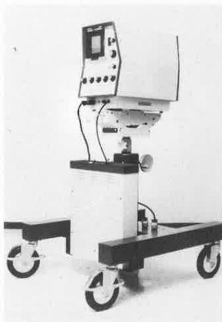
Photo 1. Le coeur de cette caméra ultrasensible aux infrarouges est constitué d'un capteur infrarouge refroidi par de l'azote liquide.
