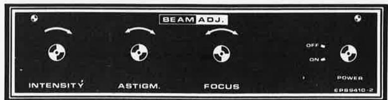
Figure 12. Face avant pour l'alimentation 2000 V.
