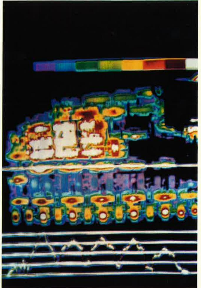
Photos 4 et 5. Thermogrammes d'un circuit imprimé. L'échelle des valeurs et des nuances n'est pas la même que pour les deux thermogrammes de la façade d'immeuble.
