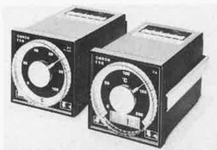
Les plages de régulation vont de - 50 à + 1200°C par l'emploi de thermocouples ou de sondes à résistance. La protection de rupture de couple et la compensation de soudure froide sont incorporées. L'alimentation est bi-tension, la sortie se fait sur relais électromécanique, un inverseur 10 A 220 VAC Cos  $\varphi = 1$ .
