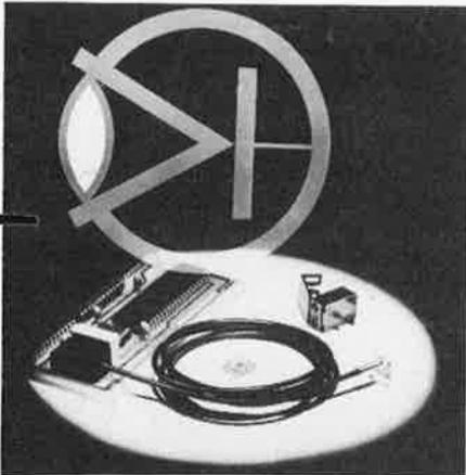
L'ingéniosité du système, référencé OPB950, consiste à pouvoir émettre et recevoir par le même composant. L'OPB950 contient, à l'une ou l'autre extrémité de la fibre optique, une diode émettrice visible (GaAs A1) montée concentriquement sur une photodiode au silicium de grande surface, l'ensemble étant placé dans un assemblage plastique. Le système existe jusqu'à une longueur de 10 mètres et permet une transmission bidirectionnelle jusqu'à 2 Mbits.
