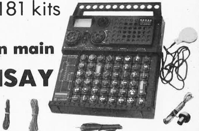
**KIT 60** Boîtier en ABS antichoc, Inter. Marche/Arrêt, Bouton de recherche de stations, Série de « Cubes composants », Ampli à C.I., Livré avec écouteur, 1 fil de 5 m et 2 fils de 60 cm, sans cellule photo-électrique, sans micro, sans appareil de mesure.
