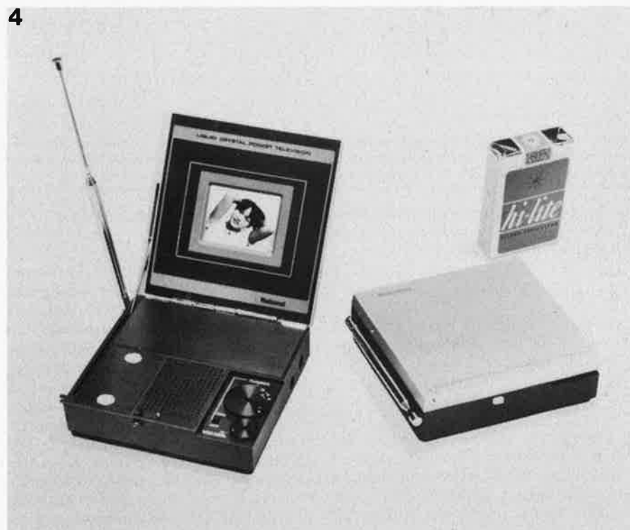
Photo 4. Un écran à cristaux liquides équipe un prototype de poste de télévision de poche, fabriqué par National Panasonic (Matsushita) comportant 57 000 points. Il fonctionne sous une tension d'alimentation de 4,6 V.
