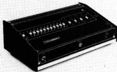
*Le Monoselektor est le fruit d'un projet d'étude réalisé par un groupe d'étude à l'Université Technique d'Eindhoven aux Pays Bas. L'exigence de ce projet initial était de réaliser un système de télécommande facilement exploitable par des handicapés. Il s'est avéré que le Monoselektor convenait parfaitement. Depuis quelque temps, un certain nombre de ces appareils ont été réalisés et donnent entière satisfaction (cela est dû pour beaucoup à leur fiabilité).*
