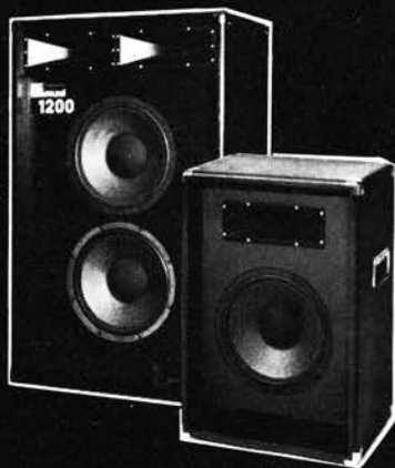
ENCEINTES ACOUSTIQUES TYPE 1121 120 W RMS, 8 Ω, 50 litres. type bass-reflex. TYPE 1200 200 W RMS, 8 Ω, 100 litres. type bass-reflex.
