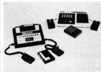
Chaque système comprend une console dans laquelle les cartouches sont enfichées. Chaque console contient l'horloge, le codeur et le modulateur, ainsi que les commandes, interrupteurs et alimentation. Les cartouches contiennent les microcircuits de chaque jeu, les circuits d'interface, et les circuits de génération de sons réalistes et d'affichage des points sur l'écran.
