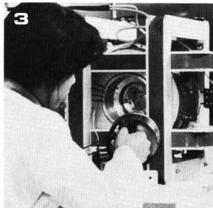
Figure 1: Le 'Silicon-repeater', qui permet de projeter plusieurs fois un même masque, réduit de 5 fois, sur une plaque de silicium, à partir d'un masque à dessin unique.
