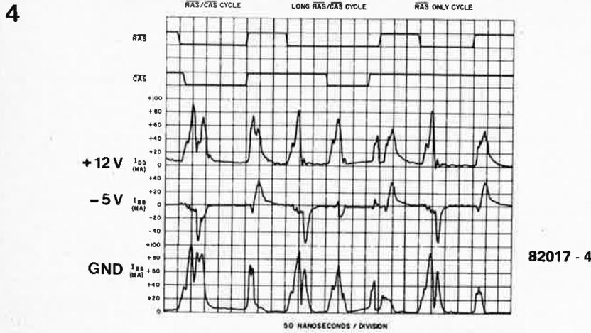
Figure 4. Relevé des courbes de consommation de courant lors des changements de niveau logique des signaux RAS et CAS. On voit que la consommation moyenne est faible, mais qu'il apparaît des pointes de courant de 100 mA; cet aspect ne doit pas être négligé lors de la conception de la carte.
