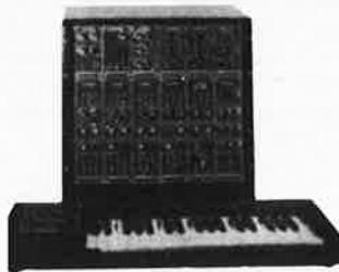
L'appareil présenté sur la photo ci-contre version de base avec un LFO, un VCF 24 dB et un RFM
