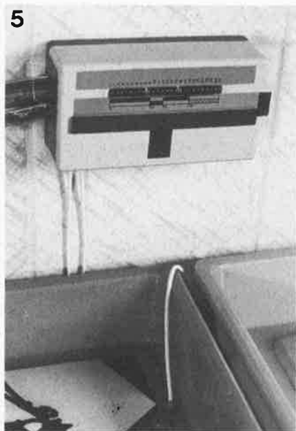
Figure 5. Voici un temporisateur installé au-dessus des baignoires, contre le mur. Le couvercle du boîtier a été doté d'une échelle amovible et les LED sont numérotées.
