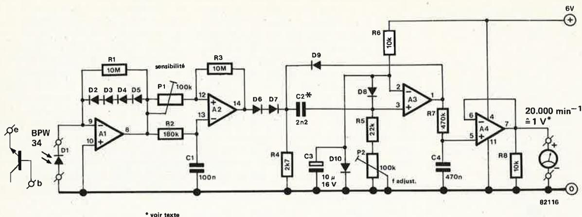
Figure 1. Le tachymètre se compose de quatre sous-ensembles: A1 est l'amplificateur de luminosité, A2 le trigger de schmitt, A3 le multivibrateur monostable convertisseur de fréquence/tension et A4 le tampon de sortie. Si l'appareil est prévu pour n'être utilisé qu'en extérieur, on pourra remplacer la diode D1 par un phototransistor. La tension de sortie maximale pourra être adaptée à l'indicateur choisi en modifiant la valeur de C2.
