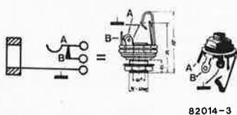
Figure 3. Toutes les prises sont du type jack châssis mono de 6,3 mm avec rondelle d'isolation, pour éviter tout faux-contact. On voit ici comment les connecter.
