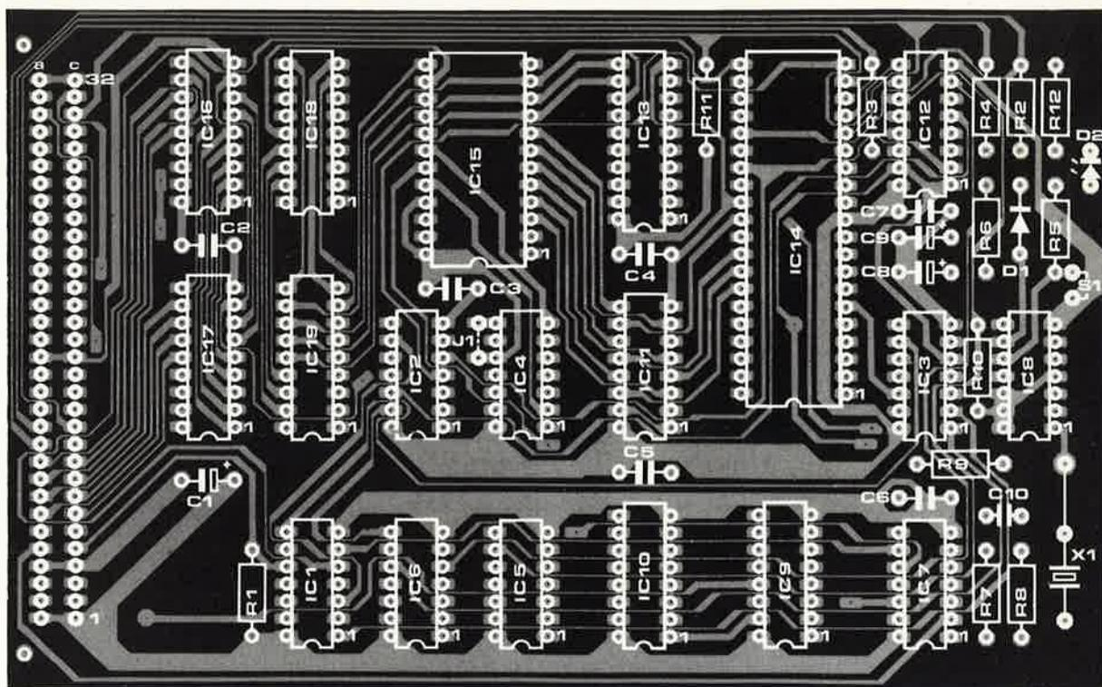
Figure 2. Dessin du circuit imprimé et sérigraphie pour l'implantation des composants de la carte CPU.
