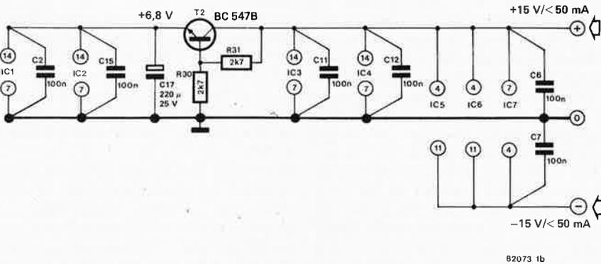
Figure 1. Le circuit de l'indicateur de tolérance ne comporte aucun composant de précision. Et pourtant, il permet l'indication de tolérances entre deux résistances jusqu'à 0,25%, pour le cas de mesures relatives. Il va de soi que pour des mesures absolues (par rapport à une valeur nominale), il faut disposer d'une résistance étalon.
