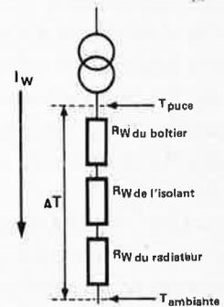
Figure 6. L'augmentation de la température de la puce par rapport à la température ambiante est due à la résistance thermique entre la puce et l'espace environnant. La production de chaleur (due à la dissipation) se fait quelle que soit la température et peut de ce fait être représentée sous la forme d'une source de courant. Le courant de "chaleur" entraîne une augmentation de la température des différentes résistances.
