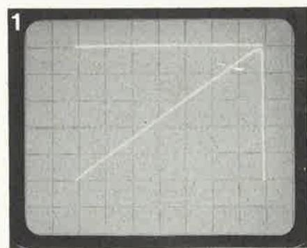
Photo 1. La courbe caractéristique du tachymètre est bien linéaire. L'abscisse est graduée en divisions de 100 Hz, l'ordonnée en divisions de 200 mV.
