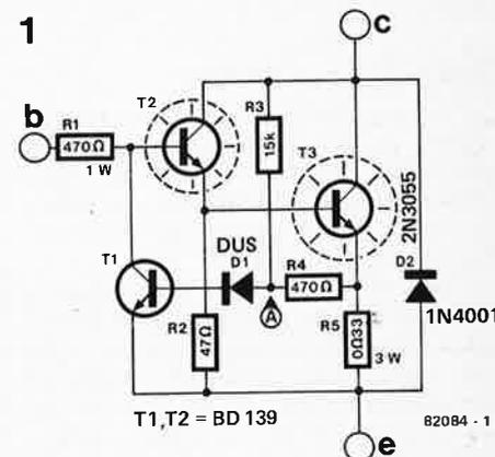
Figure 1. Schéma d'un 2N3055 "protégé". Dans ces conditions, le courant et la puissance produits par le transistor de puissance restent à l'intérieur de certaines limites. Les résistances R3 et R5 permettent de déterminer les valeurs de courant et de dissipation maximales.
