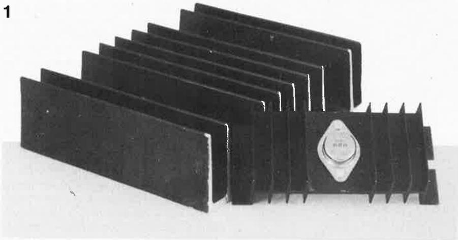
Photo 1. Voici deux types de profil fort utilisés comme radiateurs. A droite, un profil très courant: le SK03 et tout à côté, un très grand profil: le SK53, dont la résistance thermique n'est que de  $0,5^{\circ}C$ . L'utilisation de radiateurs d'une telle taille ne se justifie (économiquement) pas dans la plupart des cas.
