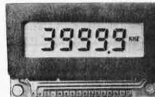
100 Hz à 120 MHz dans le creux de la main ! Qu'il soit de poche n'empêche pas ce nouveau modèle d'être de classe : une première plage nous emmène jusqu'à 4 MHz, fréquence limite pour la plupart des oscillateurs délivrant le signal d'horloge à nos microprocesseurs, la seconde jusqu'à 120 MHz couvre l'ensemble du domaine C.-Biste.
