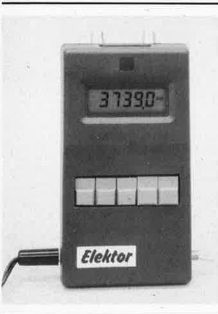
tance R28. Deuxième possibilité: remplacer cette pile par un accu CadNi équivalent; dans ce cas, il faudra mettre en place R28 de manière à permettre au courant de charge de passer lorsque le fréquencemètre est alimenté par une source de courant alternatif extérieure, source de 8...12 V.
