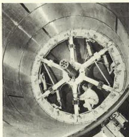
Une fois le réservoir du 1er étage complètement soudé, cet outillage de soutien est démonté et sorti pièce par pièce par l'orifice de soutirage (photo Aérospatiale).
