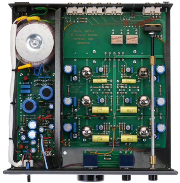
Figure 1. Les entrailles du préamplificateur MCML05. À l'arrière, près des tubes d'entrée, on aperçoit les transformateurs spéciaux pour cellule MC.
