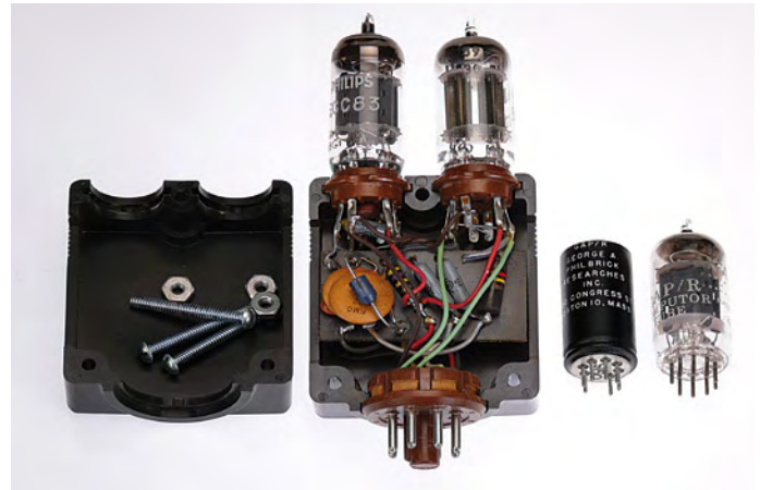
Ampli op C/50 d'Embre Electronics (ouvert par curiosité), tube « computer » de GAP/R et module « Airpax » A-175 DC-to-AC de GAP/R. (Collection de l'auteur)
