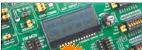
Grâce aux nombreuses nouvelles options, vous pouvez dès maintenant créer vos propres dispositifs. **EasyPIC6** supporte les microcontrôleurs PIC à 8, 14, 18, 20, 28 et 40 broches. Le **mikroICD** (débugueur matériel in situ) vous permet un débogage pas-à-pas efficace. Des exemples en **C**, **BASIC** et **PASCAL** sont fournis.
