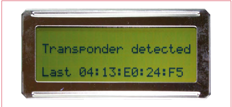
Figure 11. Dès qu'une étiquette RFID est détectée, les données collectées s'affichent sur le LCD.
