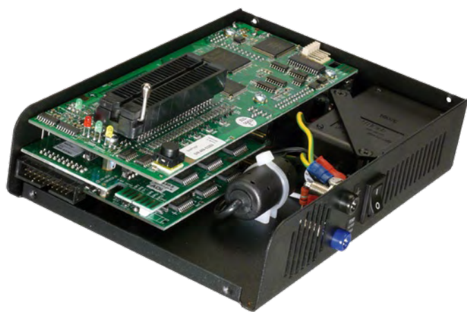
Figure 3. L'intérieur du BeeProg+ : un puissant système à microcontrôleur !
