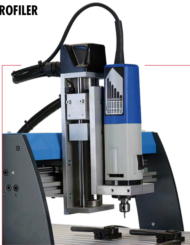
Figure 3. Le nouvel axe Z est plus robuste et plus facile à régler que son prédécesseur. De plus il possède une tête flottante. Le moteur monté ici sur l'axe Z est un IAC500 de Colinbus.
