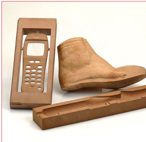
Figure 5. Quelques objets 3D usinés avec la Profiler Pro.
