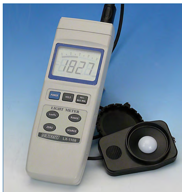
Figure 2. Impossible de se passer d'un luxmètre quand on veut connaître l'intensité lumineuse. Pour nos mesures expérimentales, nous avons utilisé un Volcraft LX-1108 qui a été aimablement mis à notre disposition par Conrad Pays-Bas.
