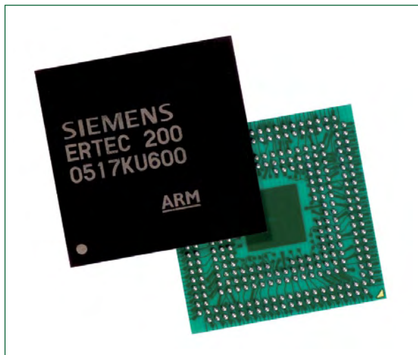
Figure 3. Le processeur ERTEC 200 de Siemens avec le processeur ARM intégré et deux interfaces Ethernet. (Source : Siemens)
