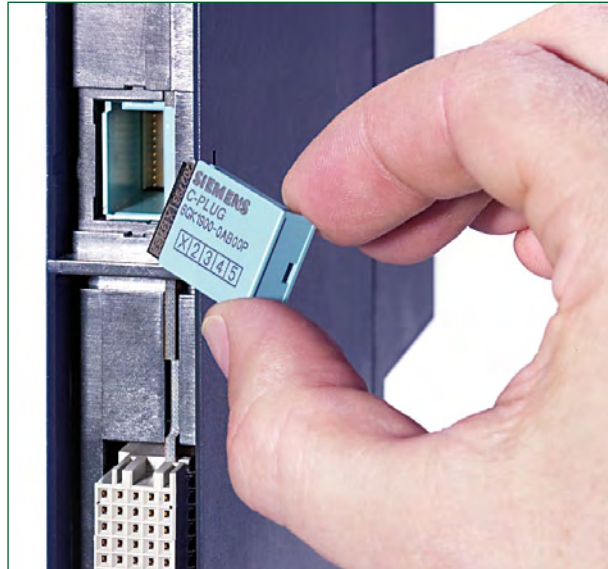
Figure 1. Le C-Plug de Siemens d'une capacité de 32 Mo. (Source : Siemens)
