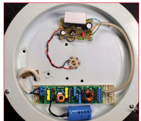
Figure 9. L'électronique montée dans un plafonnier. On peut voir un « transformateur électronique » modifié, un MPDP et une DEL OSTAR au centre.
