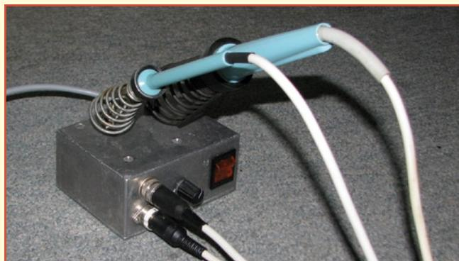
Depuis de nombreuses années j'utilise un fer à souder tout ce qu'il y a de plus standard doté d'un interrupteur magnétique en tant que régulateur de température (il s'agit, ne faisons pas de publicité gratuite, d'un Weller 24 V). Les composants électroniques ne cessant de se miniaturiser, il était temps de penser à un fer à souder pour CMS plus compact.
