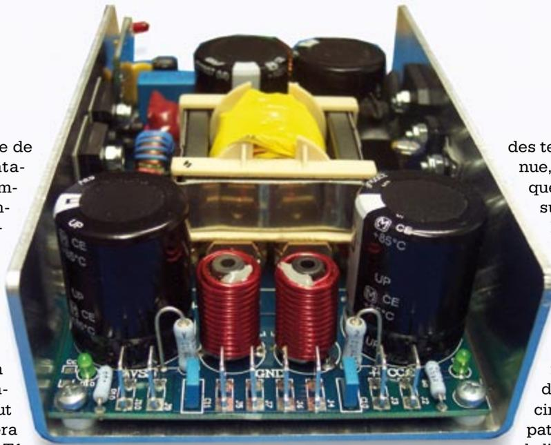
des tests de puissance continue, il est important d'appliquer une ventilation forcée sur le transformateur et les diodes de sortie.
