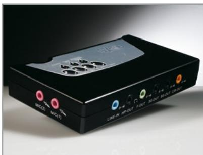
Sweex est une petite boîte en plastique bien pratique, garnie tout autour de mini prises pour jack. Il y a deux entrées micro sur le côté gauche, entrée et sortie S/PDIF (TOSLink) sur le côté droit, entrée de ligne, sortie casque et quatre autres sorties (stéréo) pour mini jack 3,5 mm en façade avant. On trouve encore trois LED d'état et quatre boutons sur la face supérieure pour compléter le tout.
