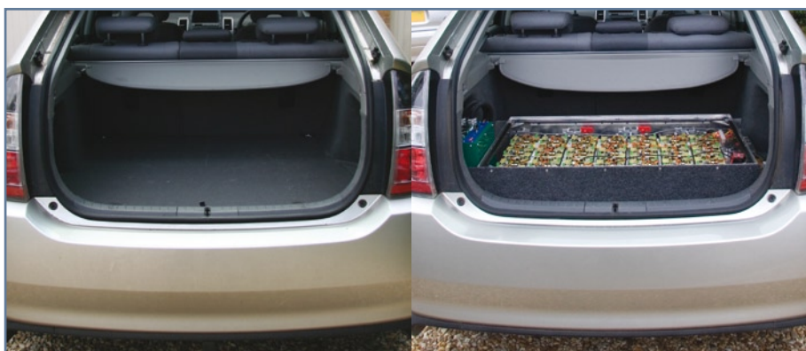
Figure 5. Photos « avant » (5a) et « après » (5b) du système de batteries.
