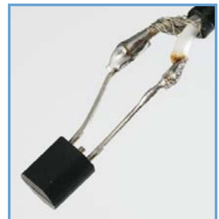
Figure 4. Le capteur KTY81 est raccordé par un câble blindé.
