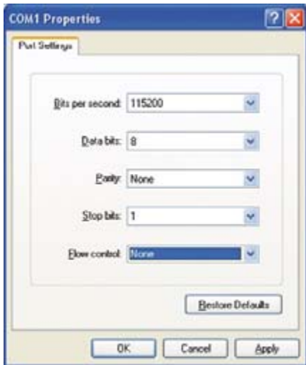
Figure 2. La communication série se fera avec le paramétrage indiqué ici.
