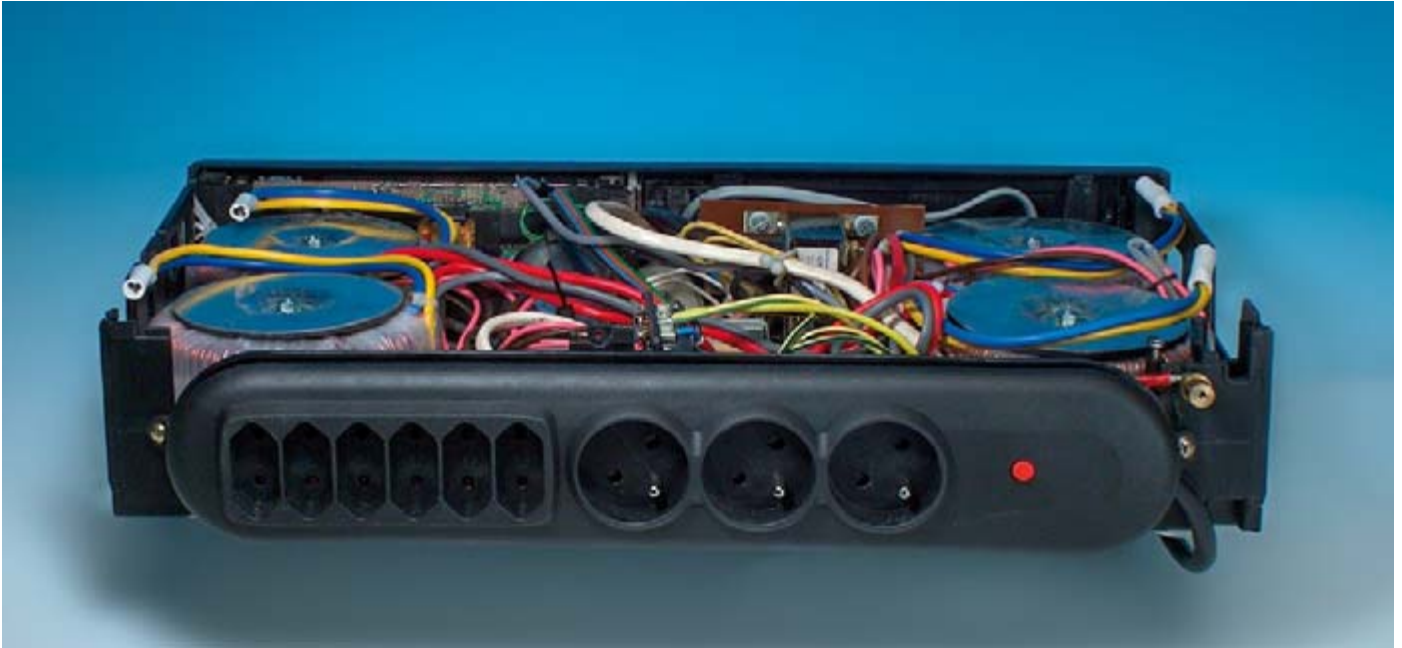
L'auteur a branché deux transformateurs en miroir de manière à perdre le moins possible et faire en sorte que l'ensemble puisse tenir dans un boîtier de faible hauteur.
