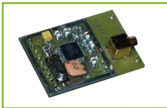
module est basé sur un émetteur-récepteur complètement intégré avec une interface numérique. Il est utilisé avec succès dans le zBOT [1].
