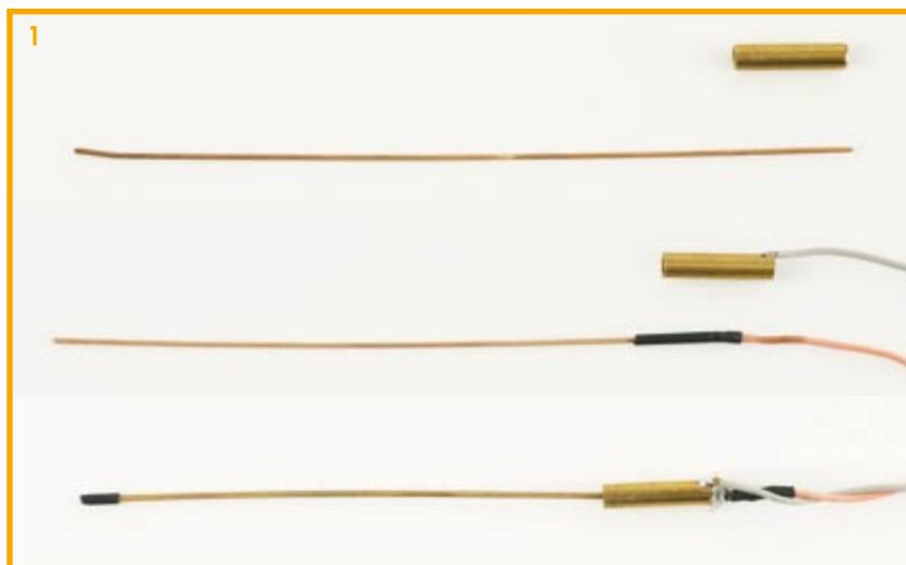
un capteur de ce genre transmet un signal au robot signifiant qu'il y a « quelque chose » là.
