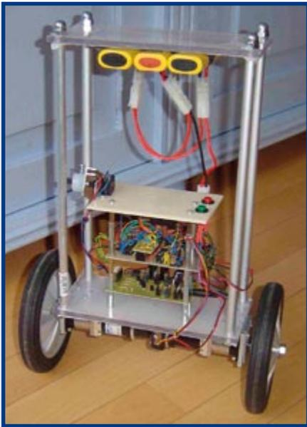
microcontrôleur de compenser le décalage dans la commande des moteurs, le robot gagnera beaucoup en stabilité. Les performances du robot, son aptitude à rester vertical, dépend également des performances des moteurs et des accumulateurs. Plus les moteurs pourront fournir d'énergie, mieux le robot pourra faire la preuve de ses talents d'équilibriste.
