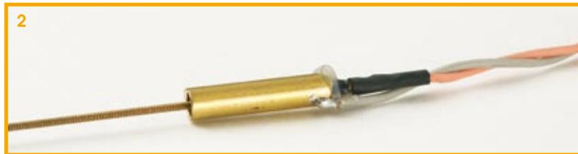
3. Déplacer la corde dans la gaine pour que seule une longueur d'environ 10 mm soit isolée à l'extrémité du manchon. Fixer la corde au centre au moyen d'adhésif à chaud. Ne pas laisser trop d'adhésif pénétrer
