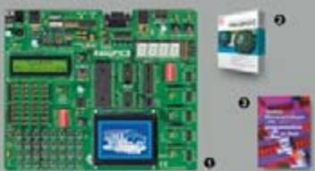
1) **EasyPIC4** Starter-kit pour développement sur microcontrôleurs PIC™ - Programmeur **USB intégré**, supports pour PIC **8, 14, 20, 28** et 40 broches, livré avec PIC16F877, emplacements pour afficheurs LCD 2 x 16 et afficheur LCD graphique 128 x 64 (**livrés en option**), 32 leds, 32 boutons-poussoirs, 4 afficheurs 7 segments, emplacement pour capteur température DS18S20 (livré en option), connecteur pour clavier PS/2 (non livré), port série, etc..... **126,00 €**
