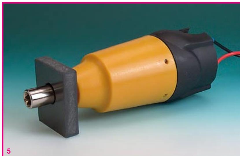
On voit, en **figure 5**, un moteur de propulsion doté de son bloc roulement à billes. Les roues de propulsion seront soit dotées d'un perçage de 10 mm pour l'axe et collés directement à l'axe soit fixés à la colle sur l'une des mèches fournies avec le tournevis électrique, cette dernière étant ensuite montée sur le moteur et fixée.
