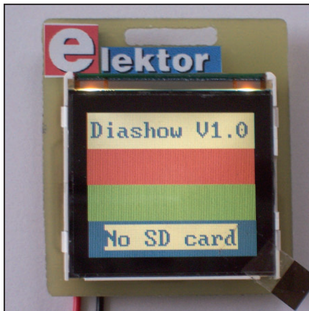
Figure 7. À la première utilisation du montage, l'AVR envoie une image d'essai.
