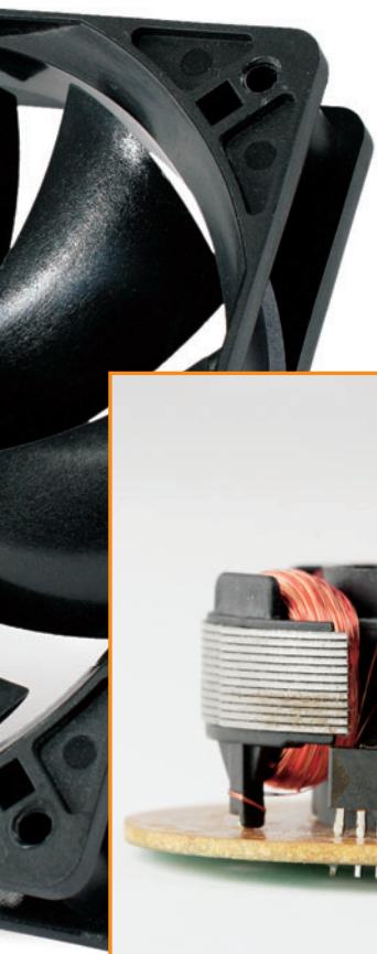
Figure 2. Générateur de champ tournant est peut-être exagéré : l'ensemble de l'électronique, y compris le capteur Hall, sont intégrés dans un circuit à 4 pattes. Il faut y ajouter un condensateur électrochimique.
