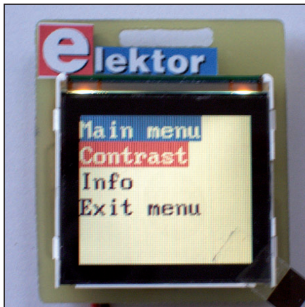
Figure 8. L'AVR commande même le réglage du contraste.
