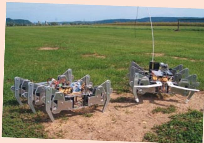
riante standard avec module à capteur ultrasonore et une seconde dotée d'un bras mobile sur lequel est fixé la caméra sans fil. Cette dernière peut, par une paire de servos additionnelles se mouvoir gauche/droit haut/bas.
