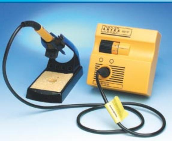
Cette station de soudage anglaise aux formes particulières est livrée avec un fer de 50 W d'un maniement assez facile. Le câble est un peu court, mais assez souple. La connexion du fer à la station s'opère par une fiche DIN qui assure également la mise à la terre du fer. La panne du fer est reliée à la terre de la prise secteur à travers cette fiche.
