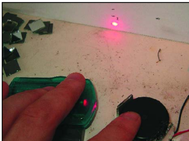
Une feuille A4 et un pointeur laser, tout ce qu'il faut pour ajuster facilement l'angle de réflexion.
