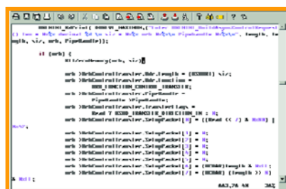
Figure 7. Le pilote oGenInt.sys a pour fonction de mettre en forme les « requests » véhiculées par le bus USB.
