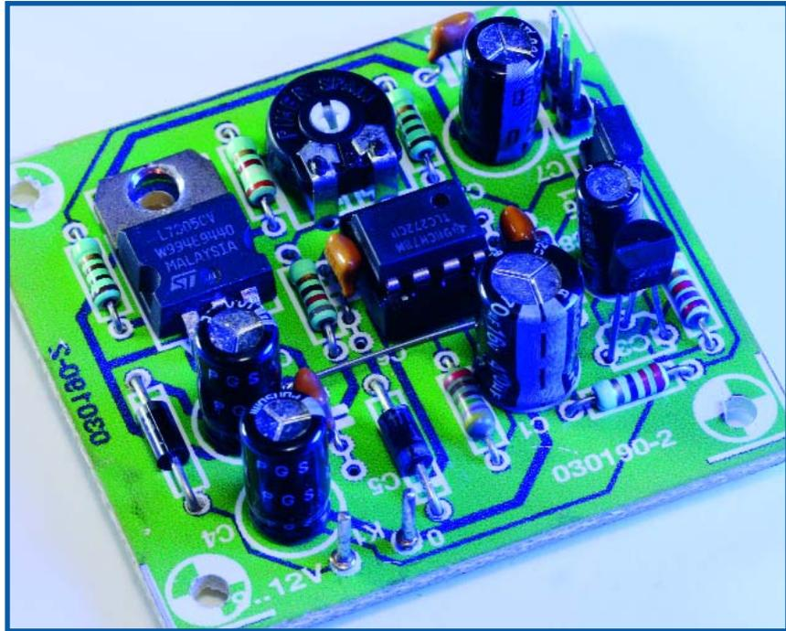
demi-degré). On dispose ainsi d'une excursion en température de 1 090 mV, ce qui implique un gain de  $5\,000$  mV/1 090 mV = 4,587x. C'est IC2.B qui se charge de cette fonction, son gain A répondant à la formule  $R7/R6 + 1$ . L'amplificateur opérationnel IC2.A commande la tension d'offset. Il paramètre la
