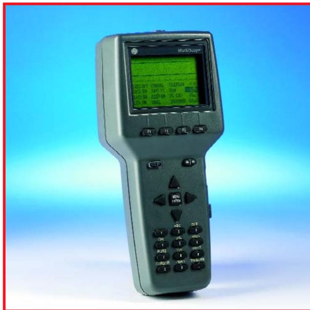
À l'image du HPS40 de Velleman, le Multiscope est un instrument relativement simple quant à ses spécifications, ce qui en limite l'utilisation. Il s'agit cependant d'une version 2 voies; il est livré avec mini-valise plastique, chargeur/adaptateur, 2 sondes, câble RS-232 et logiciel PC sur CD-ROM pour transfert sur PC des mesures relevées. Le taux d'échantillonnage est de 20 M $\dot{e}$ /s par canal. L'alimentation peut se faire à l'aide de 6 piles AA.
