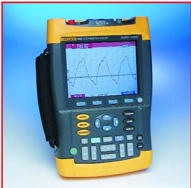
Le Fluke 199C est indubitablement un instrument de mesure d'une classe à part. Excellente spécifications. Cet appareil peut traiter des signaux allant jusqu'à 200 MHz. La fréquence d'échantillonnage est de 2,5 G $\epsilon$ /s, valeur la plus élevée des appareils testés. On a vite fait de constater que l'on a affaire à un instrument professionnel. Le 199C peut aussi servir d'enregistreur ou de multimètre classique.
