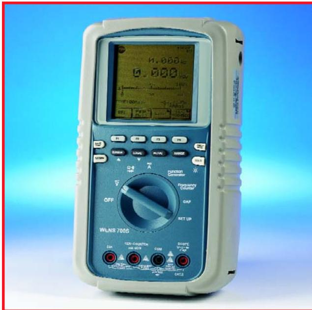
Une première impression positive. L'instrument paraît robuste avec sa face avant gris-bleu et son enveloppe grise le protégeant contre les chocs. Bien qu'un peu plus gros, il reste bien maniable. Un set d'accus NiMH de 2 x 3,6 V/2 100 mAh assure l'alimentation.
