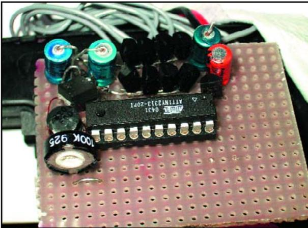
Le circuit a été monté directement sur une platine d'expérimentation sans avoir passé par quelque stade de dessin de platine que ce soit.
