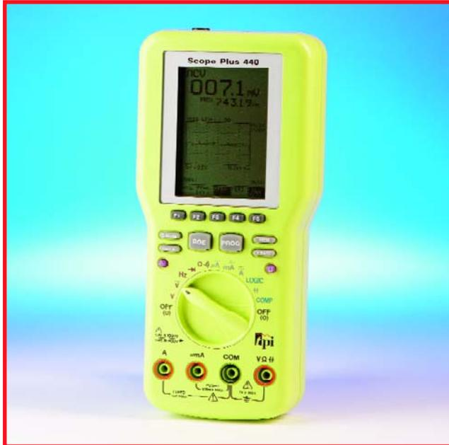
Ce scopemètre n'est pas en fait destiné aux applications en électronique. Comme le dit Merconet lui-même, c'est un « qualitémètre d'alimentation secteur » à utiliser principalement pour le test de tensions secteur dans les habitations et bâtiments industriels. Le taux d'échantillonnage n'est pas moins de 20 Mé/s. Il est également possible de visualiser sur l'oscillo les caractéristiques tension/courant de divers composants électroniques.
