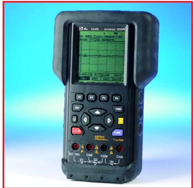
Le Seintek S2405 est le « grand » frère du S2401. Il s'agit d'un appareil relativement simple, ce qui est aussi le cas des spécifications. La fréquence d'échantillonnage est de 25 Mé/s en mode 2 voies et de 50 Mé/s en mode mono-canal. S'il est correct, ce taux d'échantillonnage est limite, pour le moins, pour des mesures sur, par exemple, un signal vidéo. Ces spécifications conviennent à des mesures simples sur des signaux audio ou autres tensions « ne grimpant pas trop en fréquence ».
