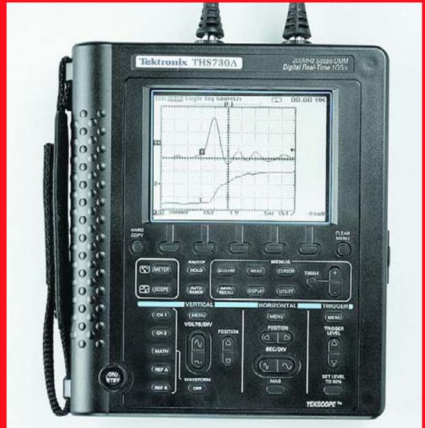
gamme débordent quelque peu du cadre. On trouve des appareils de mesure très acceptables pour moins de € 500. Le choix dépend tout d'abord des objets à mesurer. Il est intéressant de noter que la plupart des scopemètres bon marché ont une fréquence d'échantillonnage comprise entre 20 et 40 Mé/s, ce qui suffit pour la mesure de signaux d'une fréquence de quelques mégahertz. Le seul loup blanc à ce niveau est le Velleman APS230 avec 240 Mé/s et cela à un prix très abordable.
