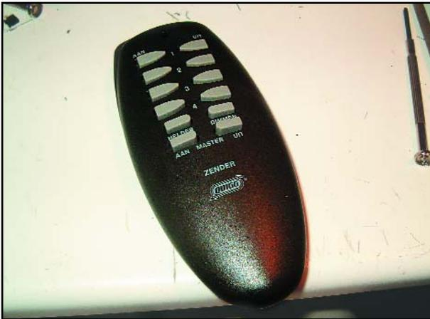
L'émetteur. Il est possible, par son biais, de piloter 4 canaux et la fonction de gradateur. On y trouve également un interrupteur général permettant une mise en/hors fonction du total.
