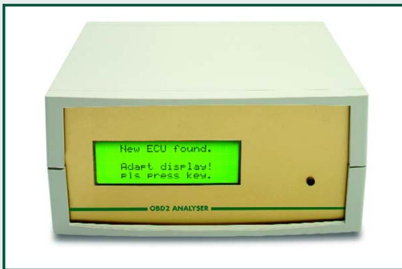
La **figure 2** montre l'intégration de notre prototype. Le boîtier est doté d'une plaque acrylique transparente faisant office de face avant, dotée d'une couche de laque sur l'intérieur. L'espace correspondant à l'affichage a été recouvert avant l'application de la laque. On réalise ainsi une fenêtre d'affichage parfaite sans perçage, découpage ou fraisage.
