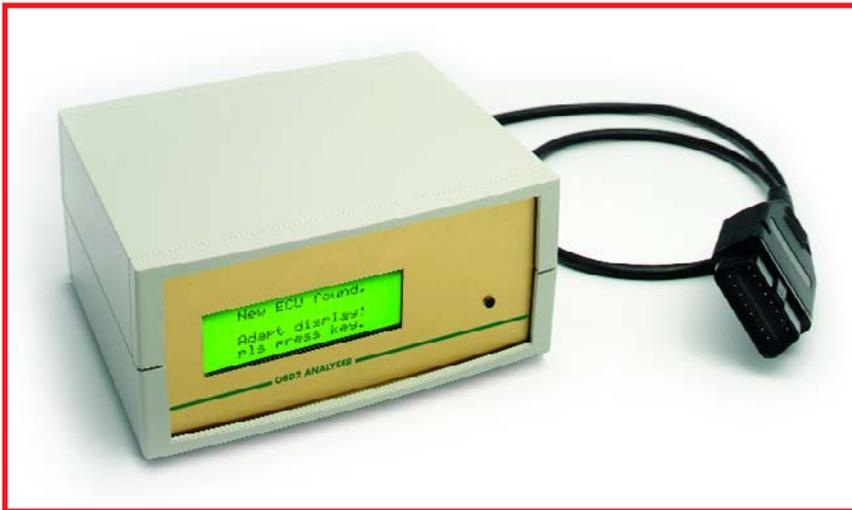
Figure 2. Le prototype de l'analyseur OBD autonome.
