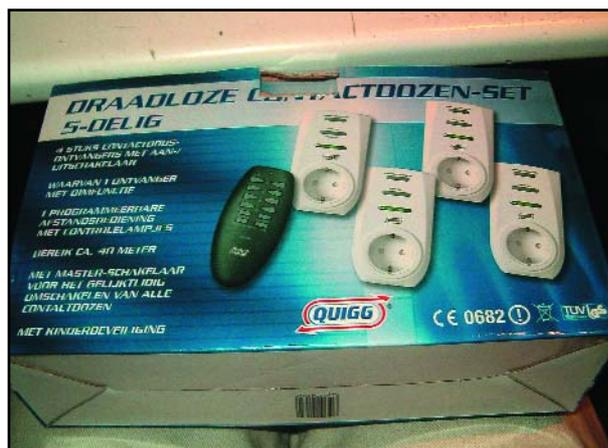
Voici les modules que nous allons utiliser. On dispose de 4 prises, l'une d'entre elles pouvant être utilisée en gradateur piloté à l'aide d'une télécommande.
