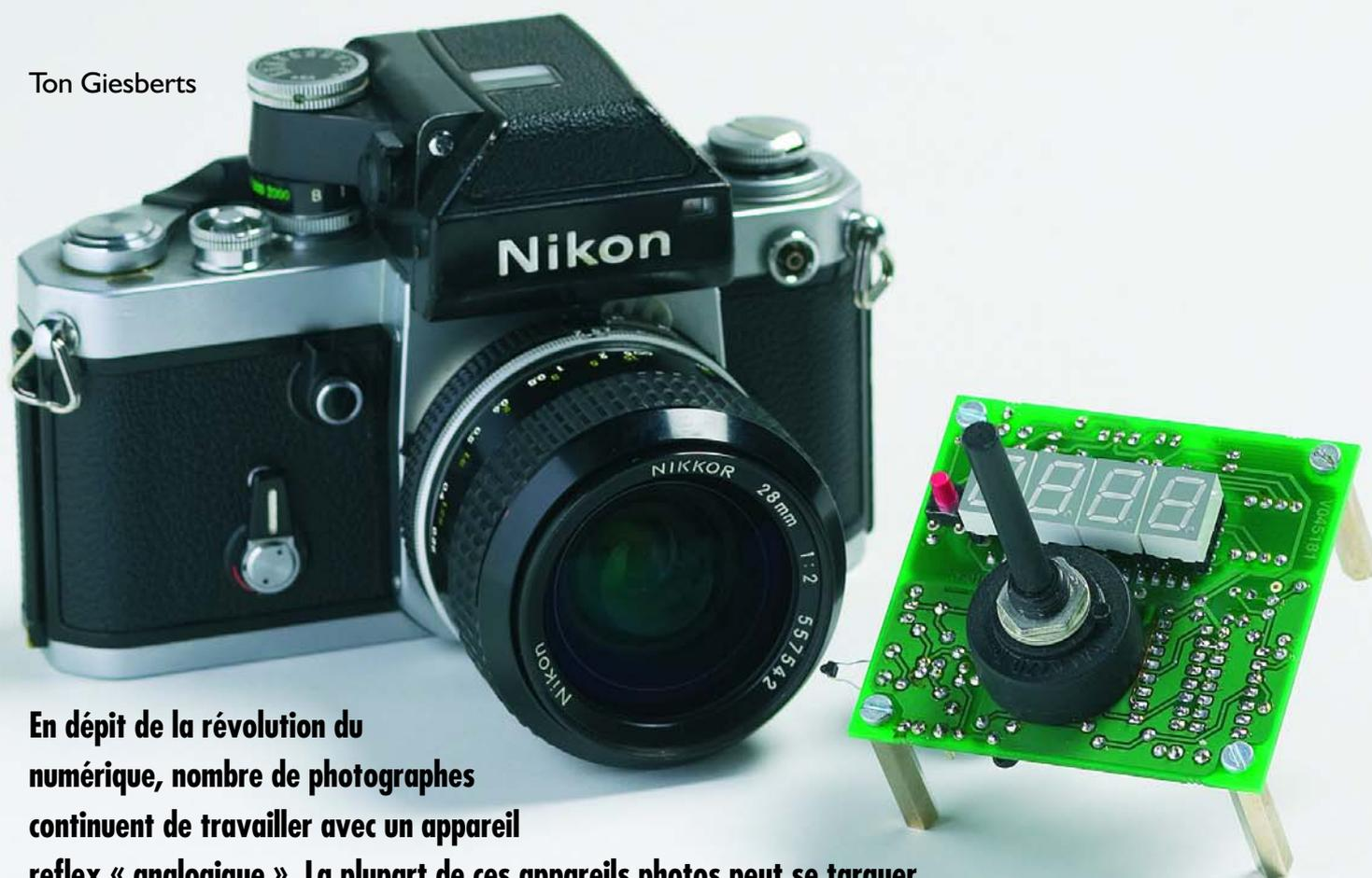
**En dépit de la révolution du numérique, nombre de photographes continuent de travailler avec un appareil reflex « analogique ». La plupart de ces appareils photos peut se targuer d'une construction mécanique solide, mais une utilisation pendant de longues années peut justifier un contrôle voire un éventuel réglage. Le présent montage permet une mesure précise de la durée d'ouverture de l'obturateur, de manière à pouvoir procéder soi-même à sa calibration.**
