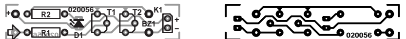
Figure 1. La platine toute en longueur trouvera place, épaulée par 2 piles micro, dans un petit tube de métal.
