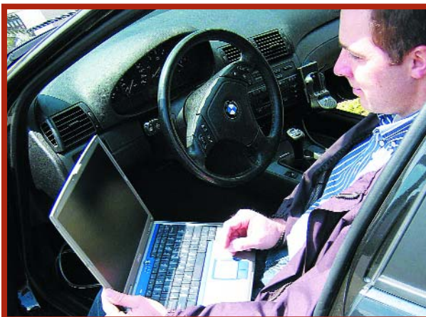
Le tuning du véhicule se fait par le biais de l'interface OBD.
