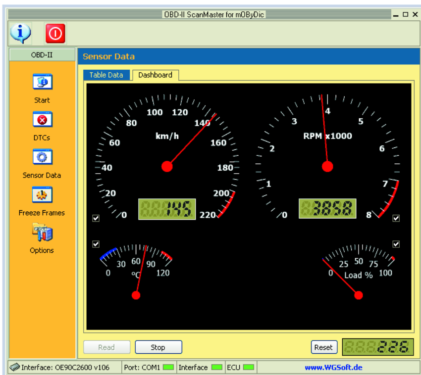
Figure 5. Les données peuvent être lues sous forme de tableau (« Table Data » en haut à gauche) ou sous forme graphique.
