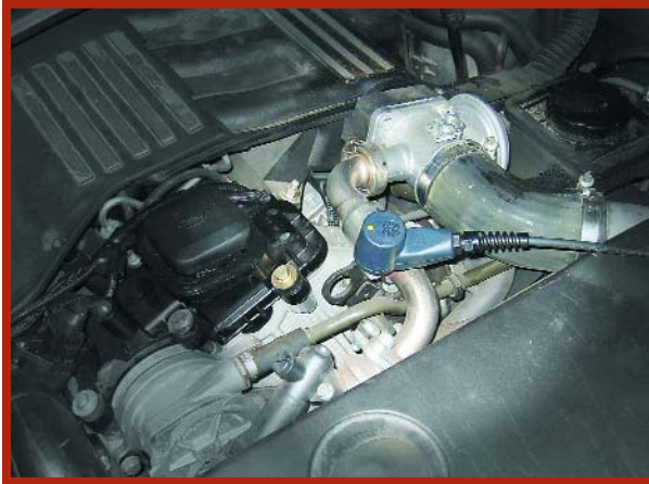
Un capteur spécial dérive le régime du moteur à partir des vibrations.
