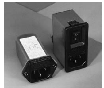
Exemple de filtre secteur standard. Il comporte une entrée secteur euro, un interrupteur marche/arrêt et un filtre efficace. Son enveloppe en métal doit être reliée au métal du boîtier.
