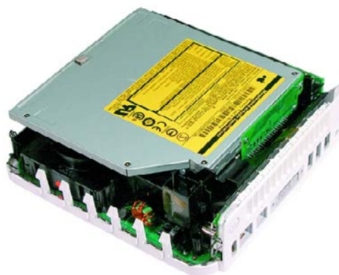
Figure 3. Mac min ouvert. On voit sur le dessus le lecteur optique ultra-plat. Il est superposé à un disque dur 2,5". On voit une partie du ventilateur de CPU noir. En haut à droite on trouve la mémoire : un classique module DDR-DIMM du type PC2700 à 184 contacts.
