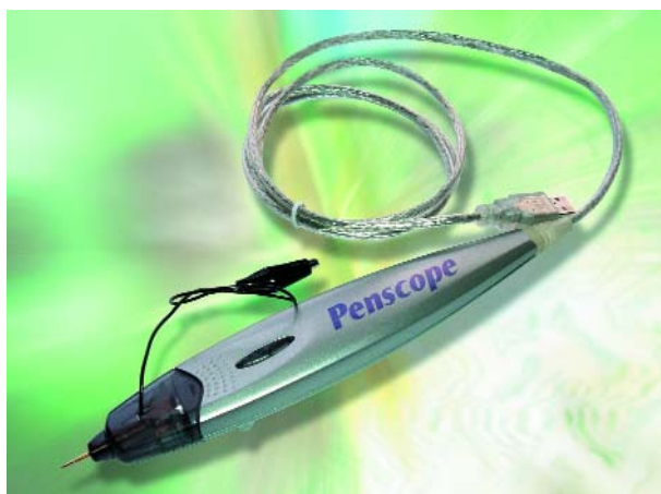
Figure 2. Le Penscope n'est pas plus gros qu'un stylo-bille mais mesure jusqu'à 40 MHz.
