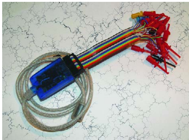
Figure 4. Les analyseurs logiques miniatures 8 et 16 canaux sont petits mais recèlent de nombreuses possibilités de déclenchement.
