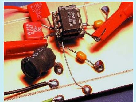
Figure 3. Montage-test de l'oscillateur.
