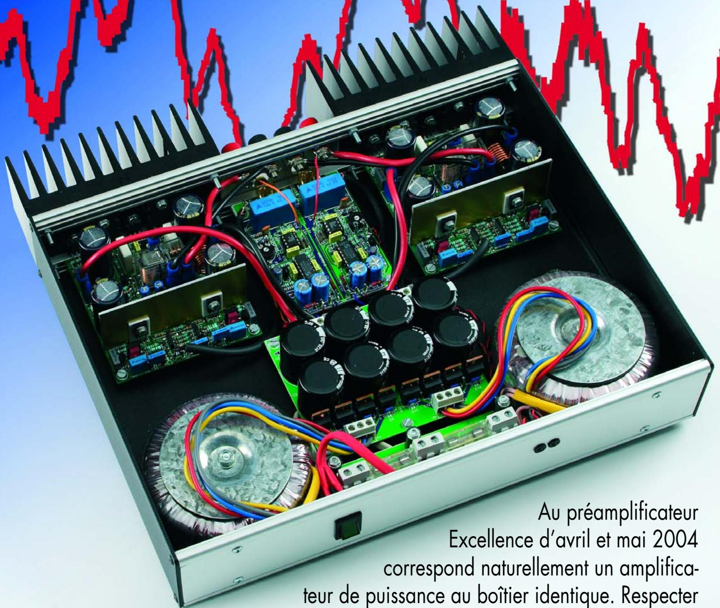
Au préamplificateur Excellence d'avril et mai 2004 correspond naturellement un amplificateur de puissance au boîtier identique. Respecter ce critère de dimensions signifie restreindre un peu la puissance de l'étage final, mais n'affecte en rien l'éminence de la qualité d'ensemble. Et le niveau sonore sera encore plus que suffisant.
