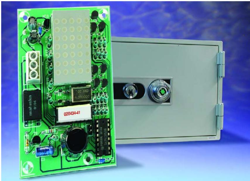
L'organe de commande de la présente serrure codée n'est pas le classique clavier à 10 touches mais en encodeur rotatif. Celui-ci simule une serrure à code pluri-chiffres.
