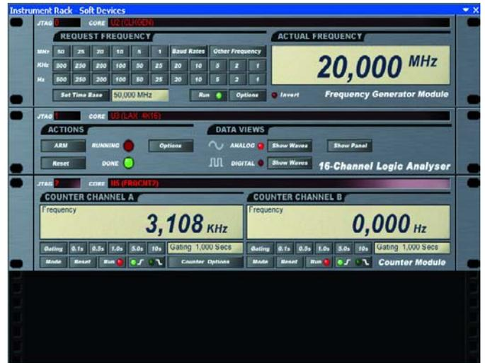
Figure 3. Ces instruments virtuels permettent d'effectuer des mesures au coeur de la FPGA.
