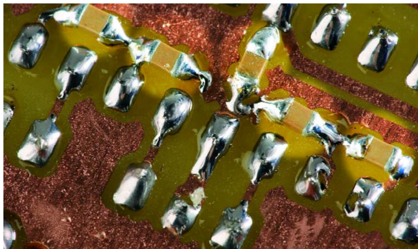
Figure 4. Certains composants doivent être montés sur la carte côté soudure.
