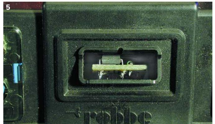
pas dans un support pour CI, le montage n'entrerait plus dans l'émetteur ! Vous signaler aussi que le pas du connecteur est de 2 mm et non de 2,54 mm comme d'habitude ! Après construction et vérification qu'il ne présente pas de court-circuit, on l'insère dans l'émetteur, côté composants dirigé vers l'antenne de l'émetteur. Il entrerait aussi bien dans l'autre sens, mais les conséquences en seraient désagréables.
