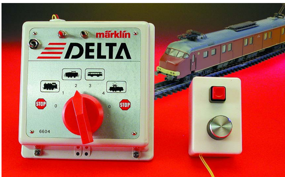
Figure 1. L'électronique du régleur manuel ne comporte pas plus de 3 composants passifs.
