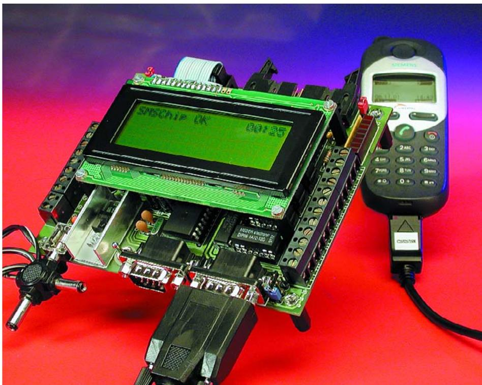
La TFH (*Technischen FachHochschule*) Georg Agricola de Bochum (RFA) a mis au point, en collaboration avec la société Engelmann & Schrader, une petite carte d'expérimentation SMS baptisée SMS ExBo (pour *Experimental Board*) qui, une fois connectée à un téléphone portable, permet le suivi et le pilotage de processus partout dans le monde.
