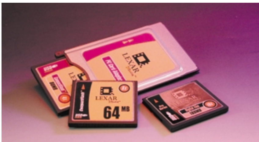
Figure 7. L'adaptateur PCMCIA de Lexar peut recevoir différents modules CF et CF+.
