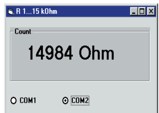
Figure 11. Mesure d'une résistance de 15\ k\Omega .
