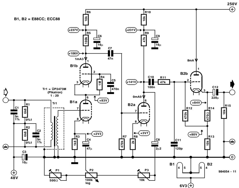
sorte que l'on élimine du même coup les problèmes rencontrés lors du réglage, souvent délicat avec ce type d'étage, de son point de fonctionnement. Le tube B2a fait office de post-amplificateur; il transfère le signal à l'étage de sortie B2b. C'est à cet amplificateur cathodique que l'on doit la très faible valeur de la résistance de sortie.
