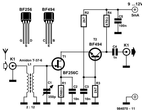
base commune se chargeant du gain de l'ensemble. Cet amplificateur a été calculé pour travailler aux fréquences comprises entre 10 et 30 MHz (et partant une bonne part du
