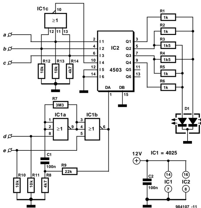
( $I_G \sim 2I_R$ ). Ici, les LED sont attaquées par des tampons 3 états du type 4503, qui contrairement à la plupart de ses congénères de la famille 4000 CMOS, est capable de fournir jusqu'à 10 mA de courant de sortie. Les résistances R1 à R6 limitent le courant à travers les LED. On pourra leur attribuer une valeur en fonction de la luminosité et des couleurs désirées. À l'origine, le circuit a été déve-
