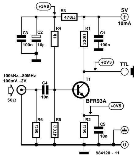
signaux rectangulaires. Nous avons, lors d'essais exhaustifs, constaté que la fréquence la plus faible utilisable est de l'ordre de 100 kHz à un signal d'entrée de 100 mV et d'environ 10 kHz en cas de présence à l'entrée de signaux de niveau TTL.
