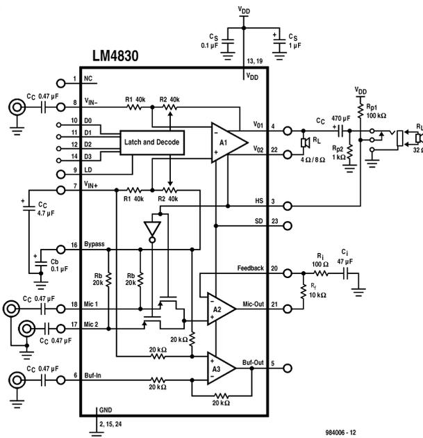
cateur à gain unitaire de sorte que l'on dispose d'une plage de dynamique de  $2,5 V_{CC}$ . Le LM4830 dispose d'une fonction de mise en sommeil (lorsque l'entrée SD (*Shut Down*) est forcée au niveau haut) caractérisée par une consommation de courant extrêmement faible de  $0,5 \mu A$  seulement de sorte que ce circuit est idéal pour les applications
