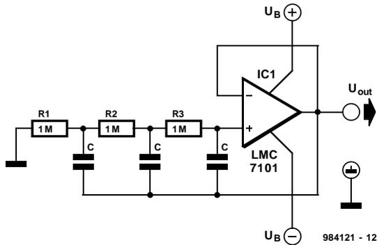
présence d'un oscillateur sinusoïdal réalisable à partir de valeurs de composants courantes pouvant travailler aux fréquences audio les plus faibles. Les schémas vous proposent un
