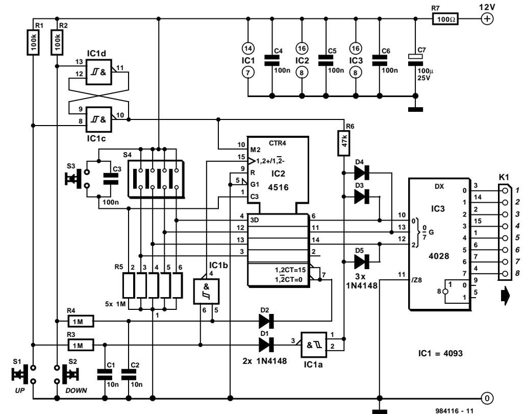
de l'impulsion d'horloge. En ce qui concerne la position minimum, on fait tout simplement appel, pour ce blocage, à la sortie de retenue (CO pour *Carry Out*) du compteur, sa broche 7. Nous avons prévu, pour remplir une fonction identique pour la position maximale cette fois, une circuiterie auxiliaire sous la forme des composants suivants : R6, D3, D4, D5, IC1a et D1. D2 force la broche 5 de IC1b au niveau bas à l'atteinte de l'état minimum tant qu'il n'y a pas d'action sur la touche « up » S1.
