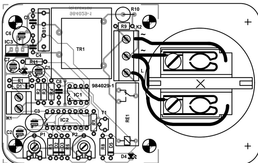
le multivibrateur monostable (MVM) IC2a. Le dit monostable définit le délai (temporisation) qui s'écoule avant la mise en fonction de la lampe. P1 permet de jouer sur la longueur de cette temporisation. Le second MVM, IC2b, sert à définir la durée d'allumage de l'éclairage, durée ajustable par le biais de P2. Une LED, D4, sert à visualiser l'activité du relais.
