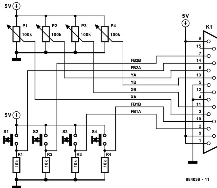
l'adresse 201<sub>HEX</sub> (cf. **figure 2**). Les 4 bits de poids fort (MSB = *Most Significant Bit*) de l'octet présent à cette adresse (bits 7 à 4) rendent les états des 4 boutons « Feu », les 4 bits de poids faible (LSB = *Least Significant Bit*), les bits 3 à 0, présentent, pendant la pseudo-période seulement, un niveau haut. Le logiciel doit donc mesurer, à l'aide d'une boucle rapide, la durée pendant laquelle un bit se trouve au niveau haut. On peut, à partir
