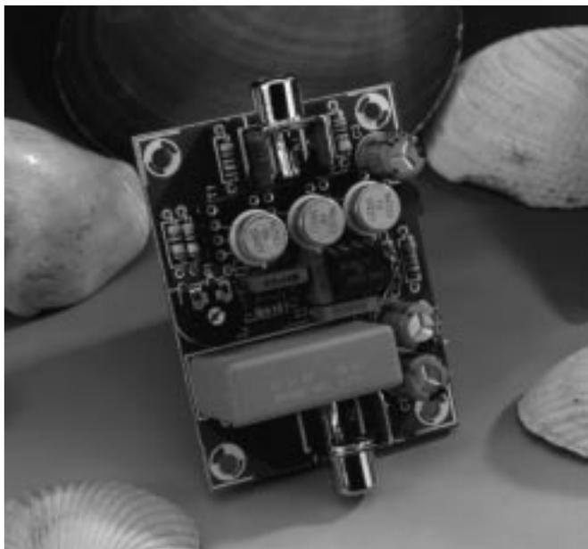
Le présent préamplificateur a été conçu à l'intention de sources de signal à faible impédance telles que cellules MC (*Moving Coil*) utilisées sur les tables de lecture haut de gamme (hé oui elles existent encore). L'impédance d'entrée réelle du préamplificateur est de 100  $\Omega$ .
