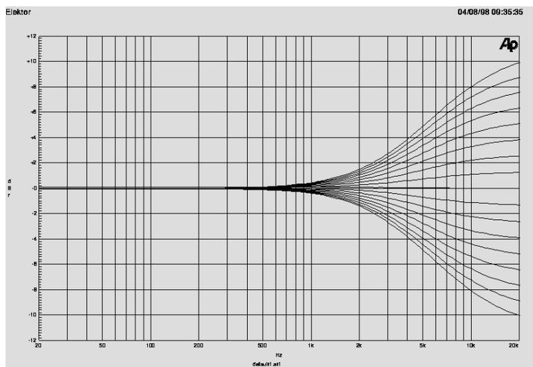
Avec le présent dimensionnement la plage de réglage débute au-delà de 20 kHz. Nous avons fixé à 11 dB le gain nominal pour être certains de disposer, à
