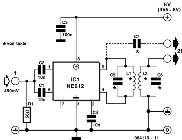
mentale, de 36-MHz ici, toutes les harmoniques supérieures se situent à plus de 25-dB en-deçà. On pourra obtenir des écarts plus importants par l'utilisation de filtres passe-bande. On pourra, en cas d'utilisation de quartz oscillant à leur fondamentale, supprimer le réseau L1/C3 accordé sur l'harmonique ainsi d'ailleurs que le condensateur de couplage-C4.
