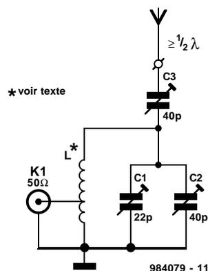
gueur de nylon. On pourrait même imaginer l'utilisation de cette USA pour syntoniser (accorder) sur une 27 MHz une longueur de fil de fer barbelé. La self présente sur le système, L1, comporte 11 spires de fil de cuivre argenté d'un diamètre de
