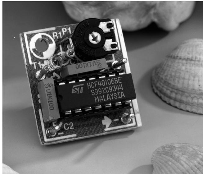
nosité ambiante à laquelle se fera le changement d'état de la sortie. On veillera à utiliser une alimentation fournissant une tension relativement propre ne dépassant pas en outre 16 V C.C. Pourquoi ne pas utiliser le dessin des pistes et la sérigraphie de l'implantation des composants que nous mettons à votre disposition ici. Ceci vous simplifiera très sensiblement la vie. Attention, lors de son montage, à la polarité du phototransistor : la broche la plus courte est celle du collecteur.
