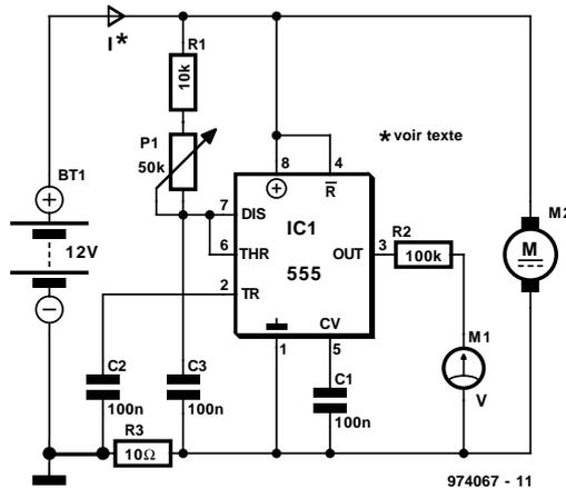
court instant, en-deçà de la 1/2 de celle présentée par l'entrée de suivi de tension (CV = *Control Voltage*) ce qui produira le déclenchement du 555. La tension de sortie du 555 sera,
