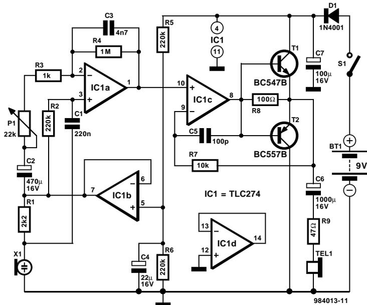
de la tension d'alimentation est assuré par le condensateur C7 monté en aval de la diode de protection contre une inversion de polarité de la tension d'alimentation, D1.
