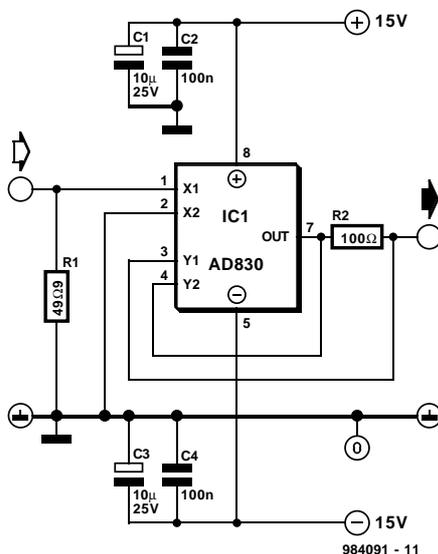
l'on obtienne l'impédance classique pour les appareils de mesure, à savoir 50  $\Omega$ , la dite résistance servant en outre au réglage en tension continue du circuit. On pourra, si tant est que la connexion à la source de courant soit courte et qu'elle soit également couplée en tension continue, supprimer éventuellement la résistance R1.
