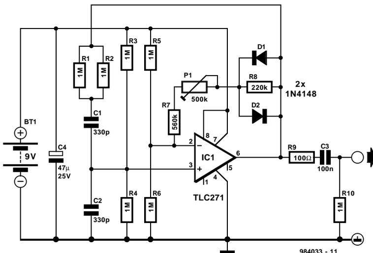
d'alimentation, les résistances R5 et R6 faisant également partie de la contre-réaction. On fixe, par le biais de P1, le gain à un facteur de 3 approximativement.
