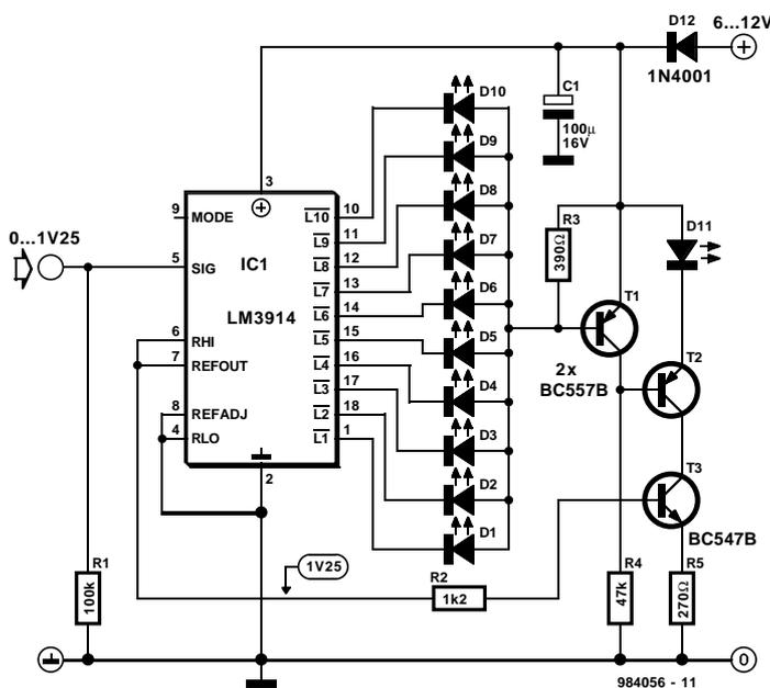
éteintes, il n'y a pas de chute de tension aux bornes de la résistance R3. Dans ces conditions, T1 bloque et partant T2 entre en conduction. Ceci permet à T3 de constituer, en combinaison avec R5 et la tension de référence interne de IC1, une source de courant qui envoie un courant constant à travers D11 : la LED d'indication s'allume alors. Dès que l'une des LED D1 à
