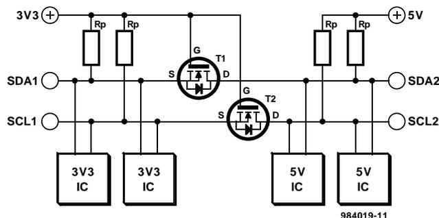
profit fait que les dits circuits intégrés travaillent tous à la même tension d'alimentation de 5 V. Il se veut cependant, que de plus en plus de composants travaillent à 3,3 V; l'électronique présentée ici permet la communication de composants travaillant à 5 V et à 3,3 V, par le biais de leur interface I<sup>2</sup>C. Ce « montage » ne comporte rien de plus qu'un unique FET par
