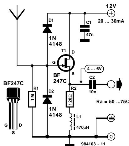
sistor aux fréquences élevées. Les diodes D1 et D2 limitent à +12,6 et -0,6 V respectivement la tension de signal.
