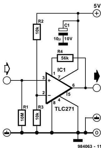
matique de l'impédance d'entrée très élevée caractérisant, à l'origine, un amplificateur opérationnel CMOS.
