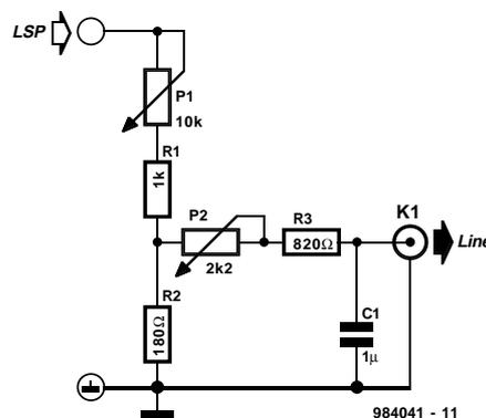
enceinte descende suffisamment dans le grave cette idée pourra prendre vie à condition de la doter d'un filtre ne laissant passer que les graves jusqu'à, disons, 100 voire 150 Hz. Et c'est bien là précisément ce que
