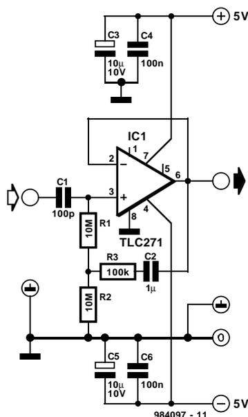
Dans le présent schéma, R1+R2 constituent la résistance de définition du réglage en courant continu. En l'absence de mesures additionnelles, l'impédance d'entrée serait de 20 MΩ. On procède cependant, par le biais du réseau C2/R3, à un couplage actif en phase d'une partie du signal d'entrée, de sorte que l'on aura circulation, à travers R1, d'un courant alternatif plus faible. Ceci nous donne, avec le présent schéma, la valeur d'impédance d'entrée donnée par la formule suivante :
