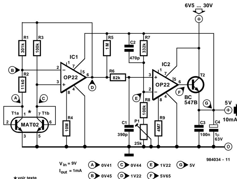
$V_{in} = 9V$     A) 0V41    C) 0V44    E) 1V22    G) 5V
