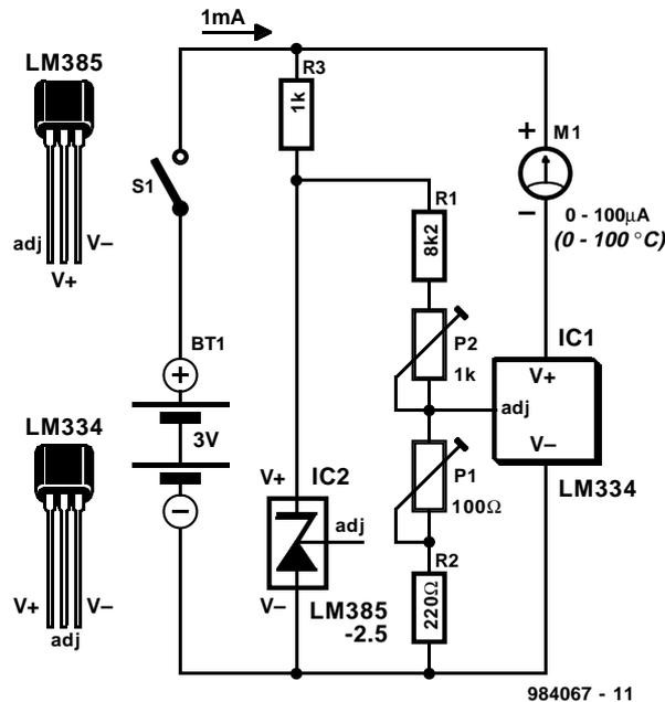
rence du type LM385-2.5, IC2, crée une tension de référence de 2.5 V. Au niveau du capteur LM334 le paramétrage en cou-
