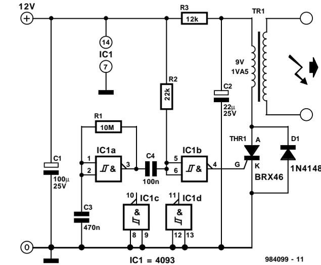
même, le condensateur C2 se voyant cependant chargé en polarité inverse de sorte qu'il adopte une polarité négative. Lorsque le transformateur a rendu au condensateur l'énergie qu'il avait stocké, le sens de circulation du courant s'inverse et le condensateur C2 chargé négativement se décharge à travers la
