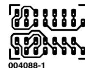
dront se ficher dans le support du CI quadruple d'origine. L'important, c'est de bien repérer le brochage des CI doubles, autant que du quadruple qu'il s'agit de remplacer. La plupart, il est vrai, observent une configuration standardisée, mais on trouve çà et là des exotismes.
