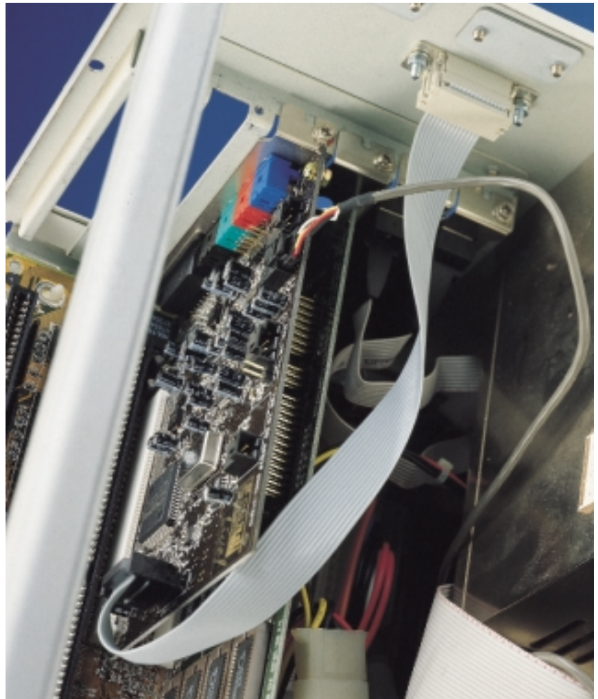
Figure 4. Voici comment, par le biais d'un connecteur Sub D vissé dans une découpe faite dans le coffret de l'ordinateur, prolonger les bornes du connecteur d'extension de la SB Live! Value.
