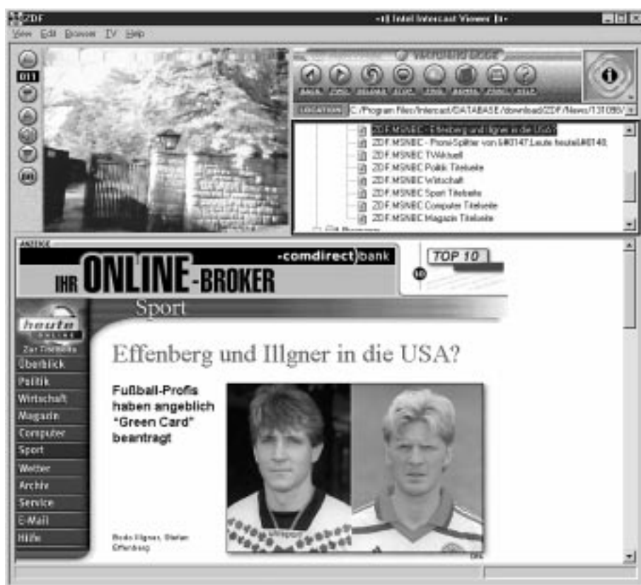
Figure 1. L'Intercast-viewer montre en haut à gauche l'image TV, et à côté le panneau de commande donnant le panorama des pages reçues. On voit, dans la partie inférieure de l'écran, la page choisie.
