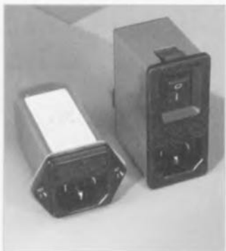
Exemple de filtre secteur standard. Il comporte une entrée secteur euro, un interrupteur marche/arrêt et un filtre efficace. Son enveloppe en métal doit être reliée au métal du boîtier.
