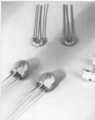
Les filtres en T ou en pi évitent l'entrée ou la sortie de parasites par les lignes de signal. Il en existe divers modèles pour différents courants et plages de fréquence.
